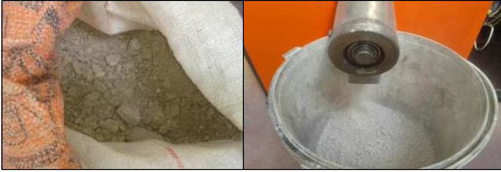
Şekil 4.16. Sisteme giren ve çıkan çimento çamuru
