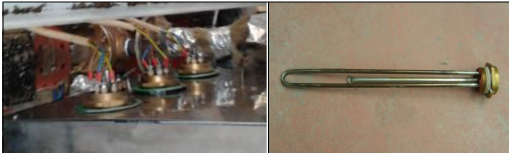
Şekil 3.28. Isıtma sistemi elemanları
