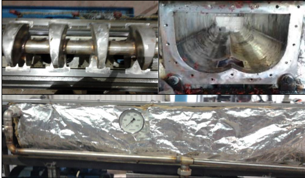
Şekil 3.26. Kükrekler ve çamur teknesi
