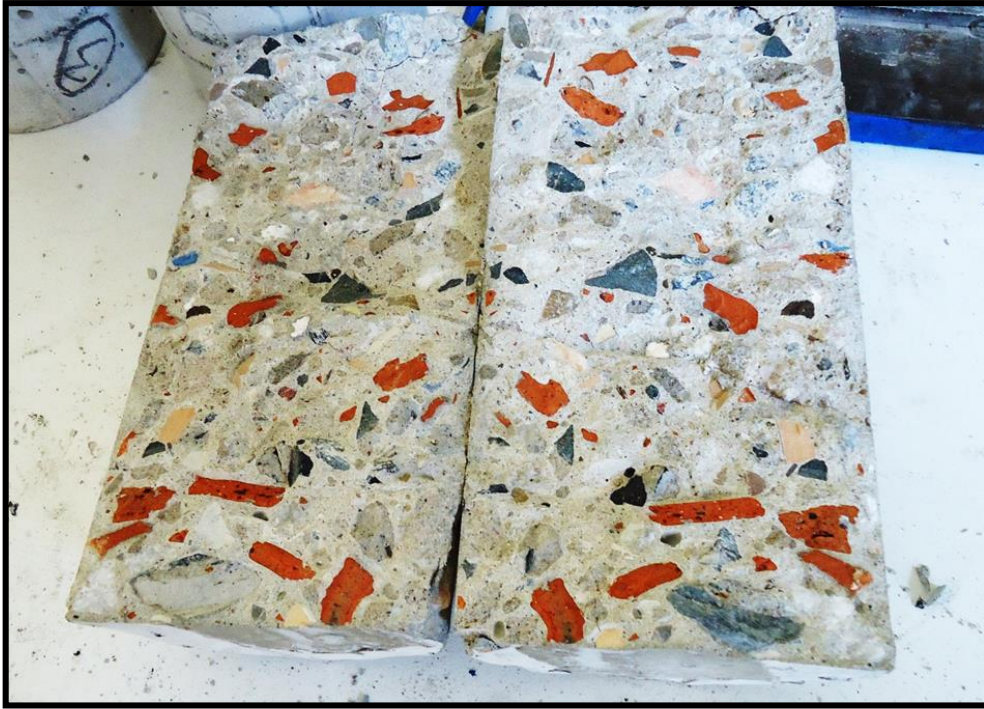
Şekil 4.1 Geri kazanılmış agregaya içeren bir betonun yarmada çekme deneyi sonucu yarılmaması ve iç yüzeyinin görülmesi (çeşitli kirlilikler çeşitli renklere sahiptir)
