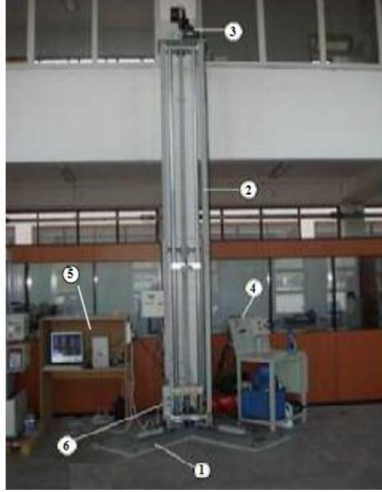
Şekil 2.5. Şenel ve arkadaşlarının geliştirdikleri darbe dayanımı ölçüm sistemi. Burada; 1) L-tabla, 2) ağırlık düşürme kulesi, 3) motor, 4) kontrol ünitesi, 5) depolama ünitesi, 6) frenleme sistemi.
