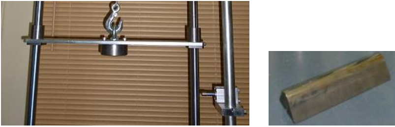
Şekil 3.12 b) Vurucu kütlesi, standarda göre değiştirilen vurucular ve çalıştırma düğmesi.
