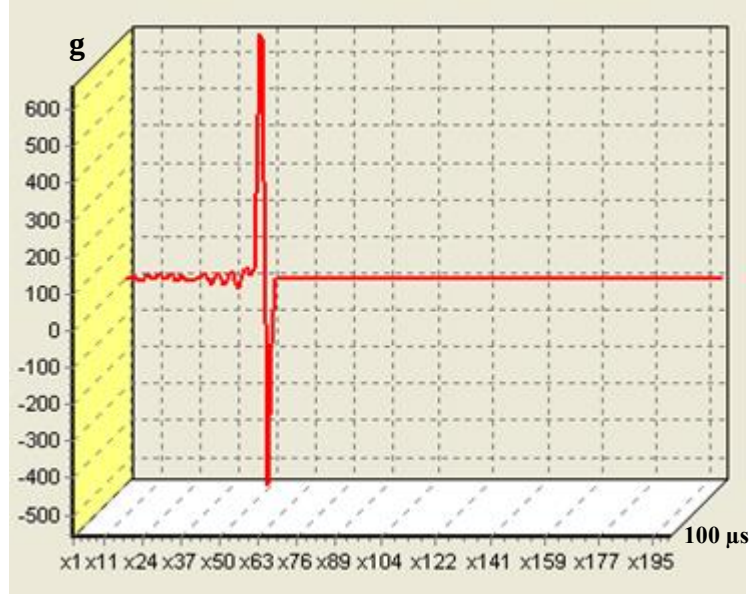
Ek 3.5. 150^{\circ}\text{C} 'de fikse edilmiş nihai eni 160 cm olan 10 mm kalınlıktaki kumaşın 25 J darbe enerji seviyesinde ivme- zaman grafiği
