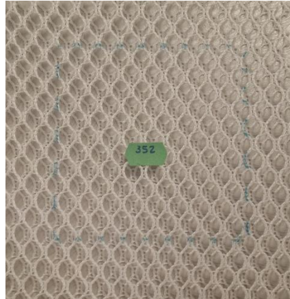
Şekil 3.8. Boyutsal değişim ölçümünde kullanılan numune boyutu.
