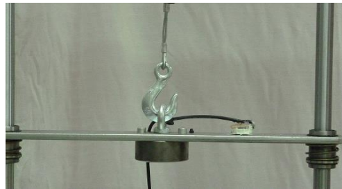
Şekil 3.12 c) Vurucu kütlesi üzerine monte edilmiş ivme ölçer.
