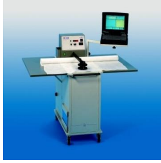
Şekil 3.6. Textest FX 3300 hava geçirgenliği ölçüm cihazı.
