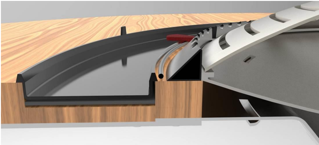
Şekil 5.25. “Kendin Hazırla, Kendin Tüket”e Dayalı Servis Tasarımı Örneği – Mangal ve Masa Kesitinin Detaylı Görünüşü
