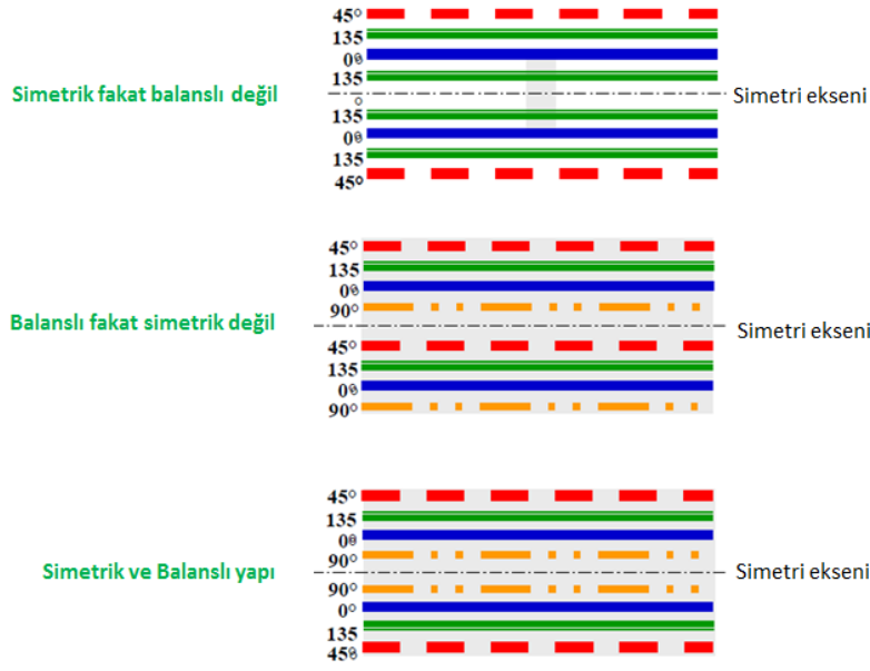
Şekil 3.16. Simetrik ve balanslı bir yapının dizilimi
