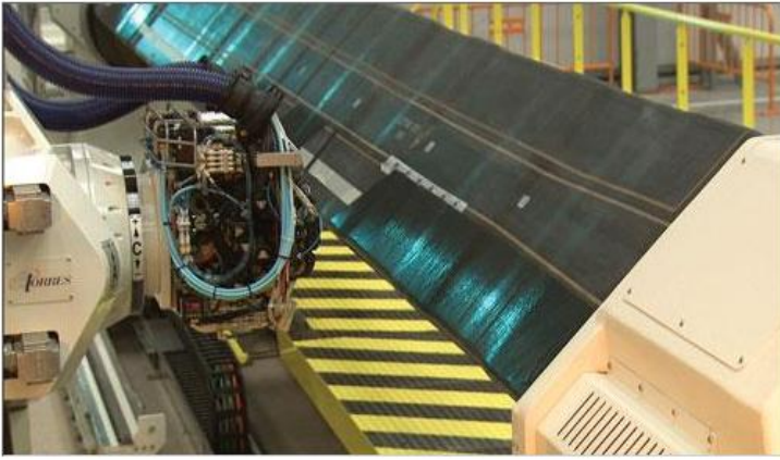
Şekil 3.12. A350 kanat kirişinin otomatik elyaf serme yöntemi ile üretimi
