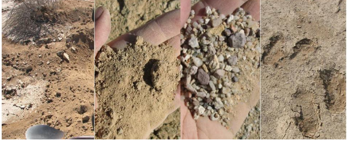
Şekil 3.13: Cuddeback Soil-B zemin tipi için farklı bölgelerden alınan zemin numuneleri.
