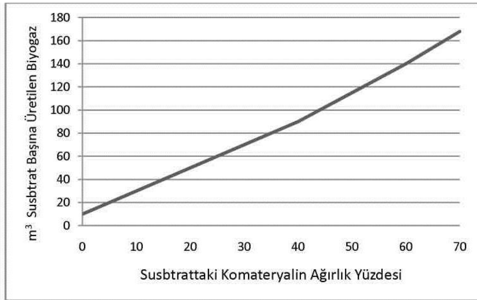
Şekil 2.7. Tarımsal tesislerde komateryal kullanımının biyogaz verimine etkisi (Deublein ve Steinhauser, 2008)
