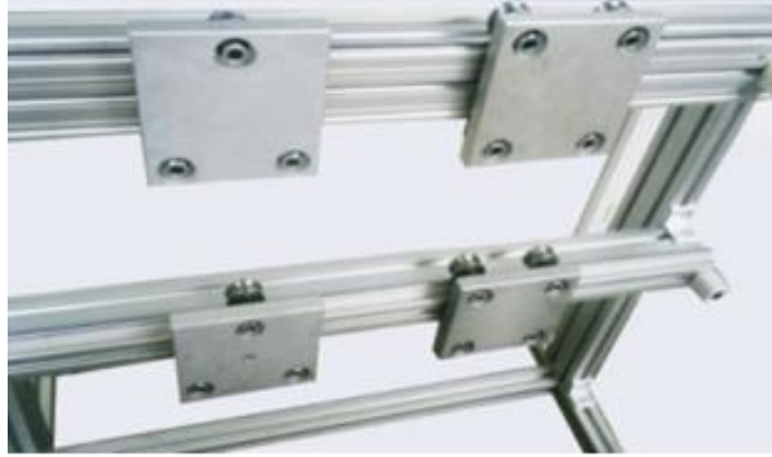
Şekil 3.3. Alüminyum lamalar ve çelik miller üzerine bindirilmiş makaralar
