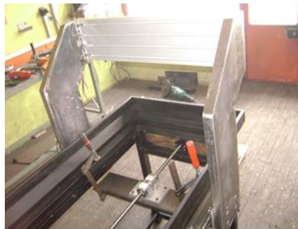
Şekil 3.1. ST-37 saclardan yapılmış ana gövde ve yan kolonlar
