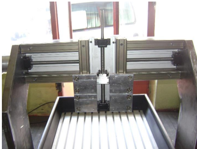
Şekil 3.5. Y ve Z eksenlerinde kullanılan bilyeli vidalı miller ve mil sonu destekleri
