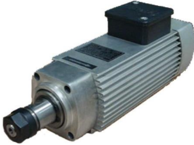
Şekil 3.7. Tasarlanan kartezyen robotta kesme işlemi için kullanılan uç işlevci (iş mili)
