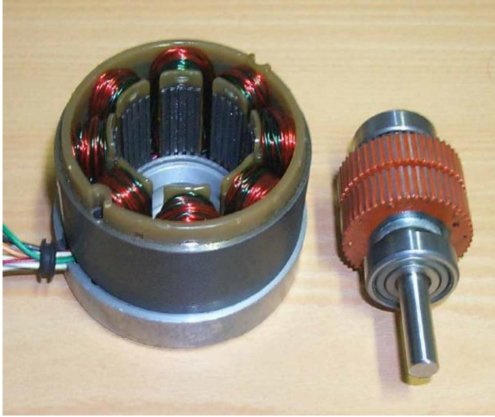
Şekil 2.6. 50 dişli rotora sahip hibrit adım motorunun iç yapısı (Gimbleby 2008)
