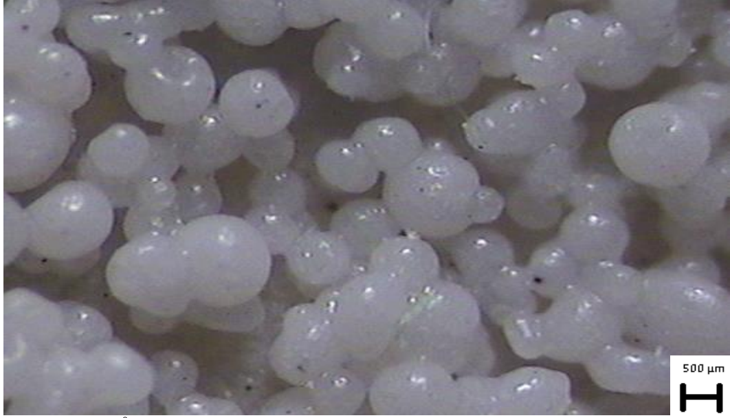
Şekil 5.2. 1190°C’de sinterlenen seramik altlık üzerindeki porselen karo granüllerin optik mikroskop görüntüsü.
