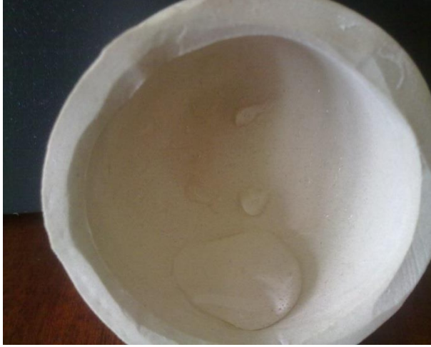
Şekil 5.15. FC seramik kroze içerisindeki su damlasının fotoğraf görüntüsü.
