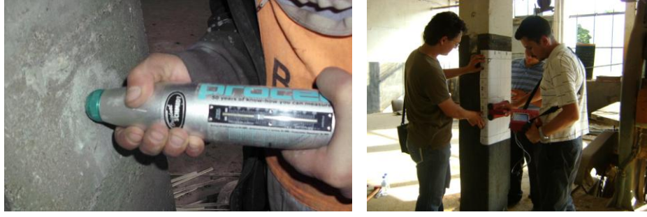
Şekil 3. 14. Beton Çekici ve Ultrasonik Ses Deneyi Uygulamaları 1
