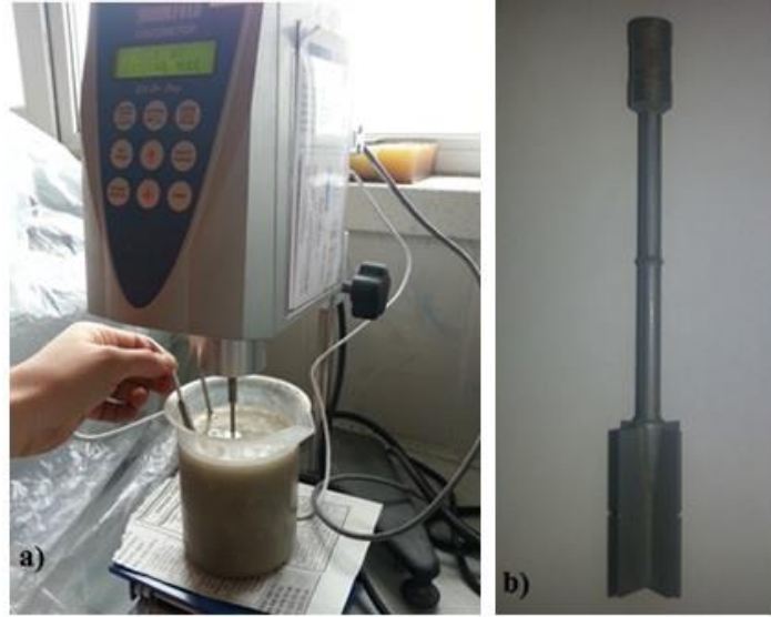
Resim 3.7 Brookfield viskozite cihazı ve kullanılan spindle a)Viskozite cihazı ve ölçümü b) V74 spindle.
