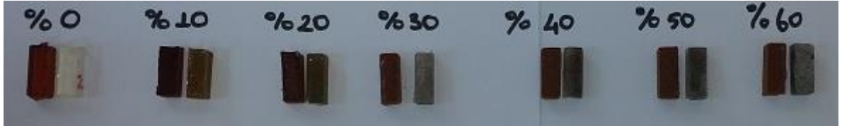
Resim 4.4 Korozyon deneyi sonrası numuneler.
