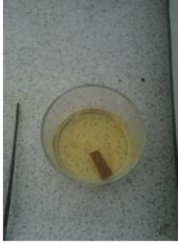
Resim 3.16 Asitlere dayanıklılık deneyi yapılışı.
