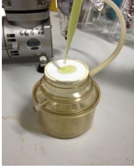
Şekil 3.8 0,45 µm' lik filtre kağıdından vakum pompası yardımı ile filtrasyon
