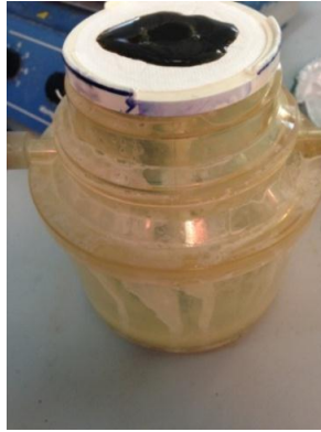
Şekil 3.17 0,45 \mu\text{m} cam fiber membran filtreden örneklerin filtrasyonu
