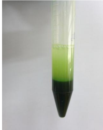
Şekil 3.10 Ultra saf su eklendikten sonra oluşan metanol-yağ fazı
