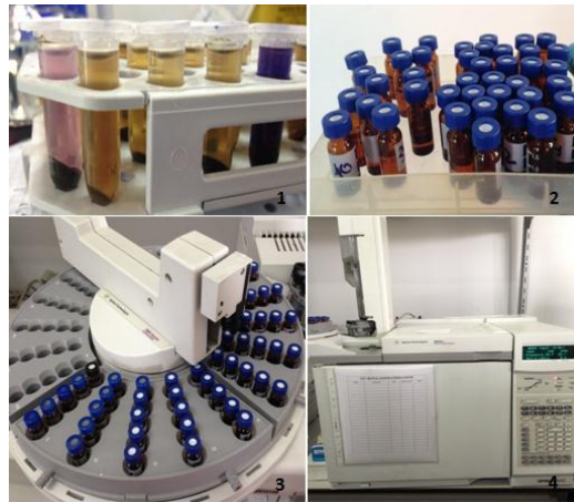
Şekil 3.18 Uçucu yağ asidi (VFA) analizi. 1- Santrifujlenmiş ependorf tüpler, 2. Filtreden geçirilmiş örnek içeren viyaller, 3.Gaz kromatografisine yerleştirilmiş örnekler, 4. Gaz Kromatografisi - 6890N Agilent Technologies Network GC System
