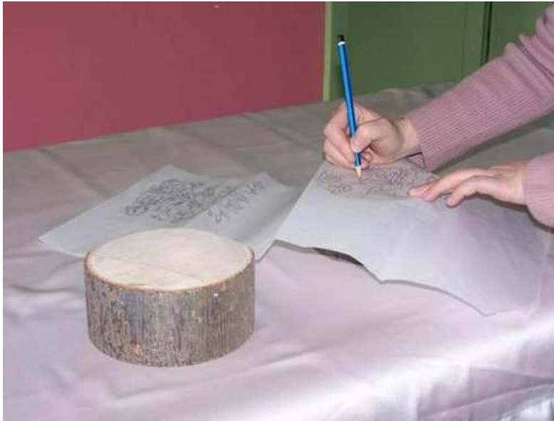
Resim 1.12: Desenin Ihlamur Ağacı Üzerine Aktarılması
