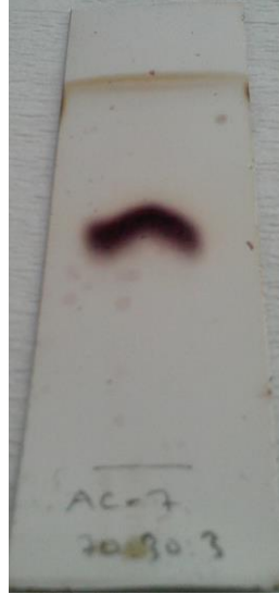
Şekil 4.8. AC-7 molekülünün İ.T.K. profili (Çözgen sistemi 70:30:3-CHCl 3 :MeOH:H 2 O)
