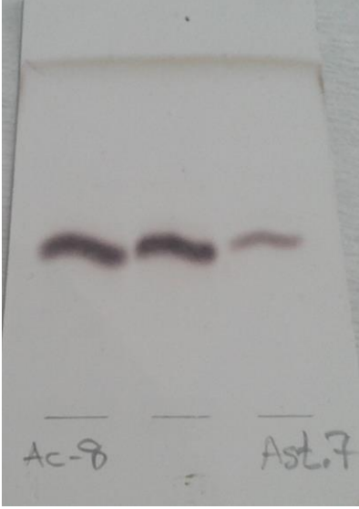
Şekil 4.7. AC-8 molekülünün İ.T.K. profili (Çözgen sistemi 70:30:3-CHCl 3 :MeOH:H 2 O)
