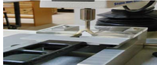
Şekil 3. 2. Hamurun Kieffer düzeneğinde uzatılması
