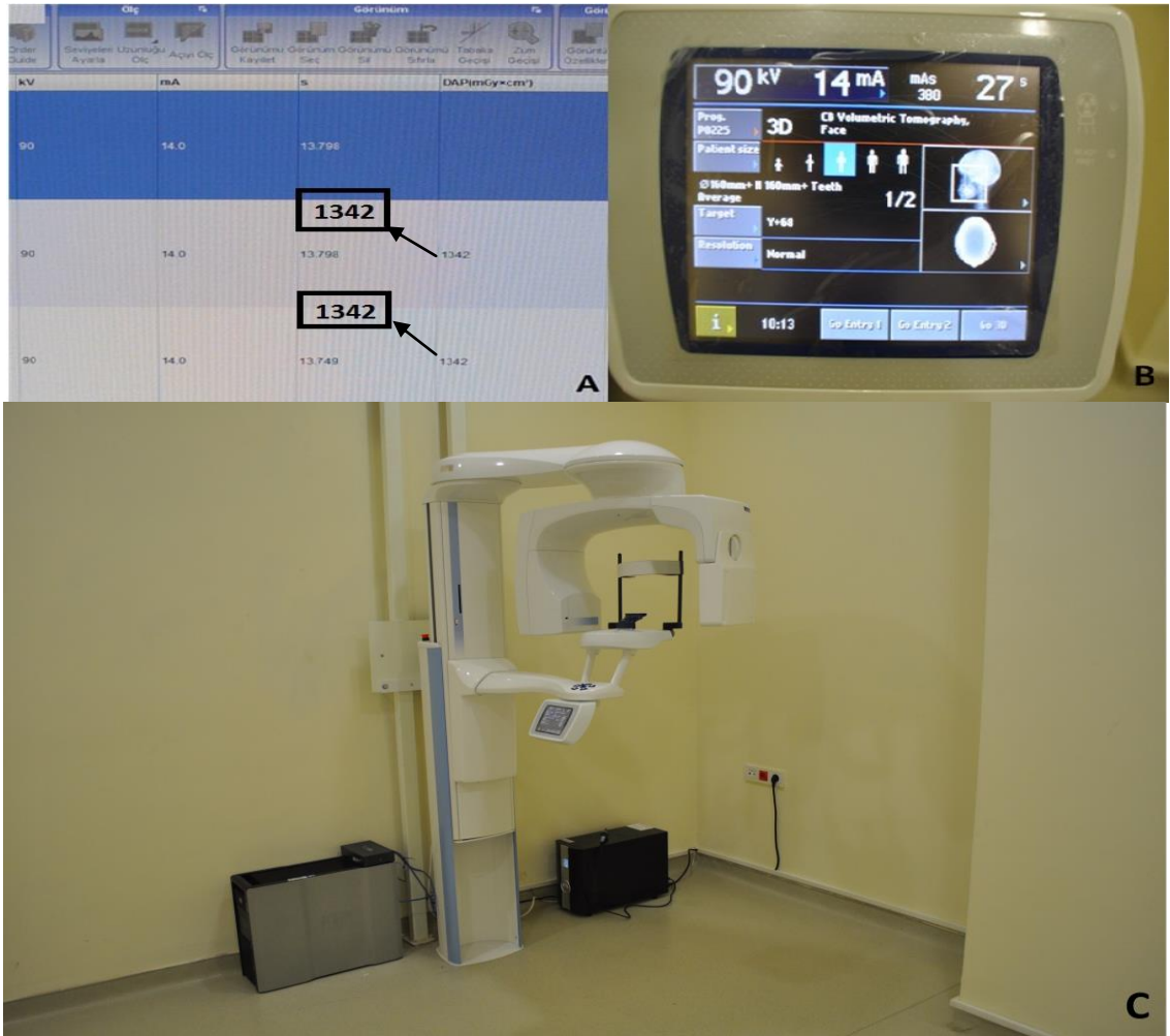
Şekil 3.1. (A) Hastaların maruz kaldığı radyasyon dozu (ok) (B) Ekspojuir parametreleri (C) Dental Volumetrik Tomografi cihazı (Planmeca 3D Mid)
