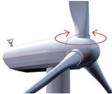
Şekil 3.13. Pitch kontrol sistemiyle kanat açısı değişimi (URL-6)
