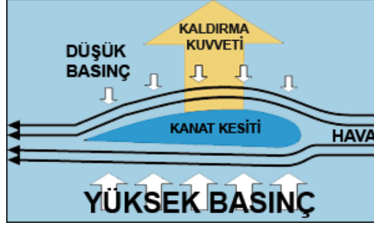
Şekil 4.2. Aerofoil etrafındaki hava hareketi ve kaldırma kuvveti oluşumu (URL-18)
