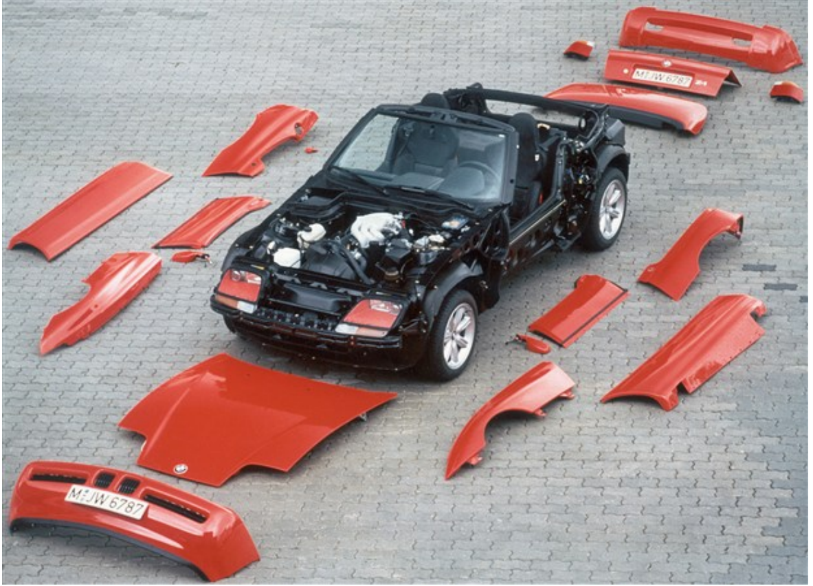
Şekil 1.23 Plastik gövde panelleri sökülmüş bir BMW Z1
