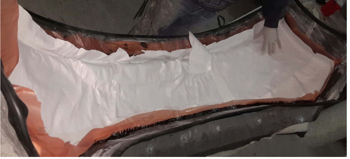
Şekil 5.13 Reçinenin emilmesi için konulan keçe tabaka
