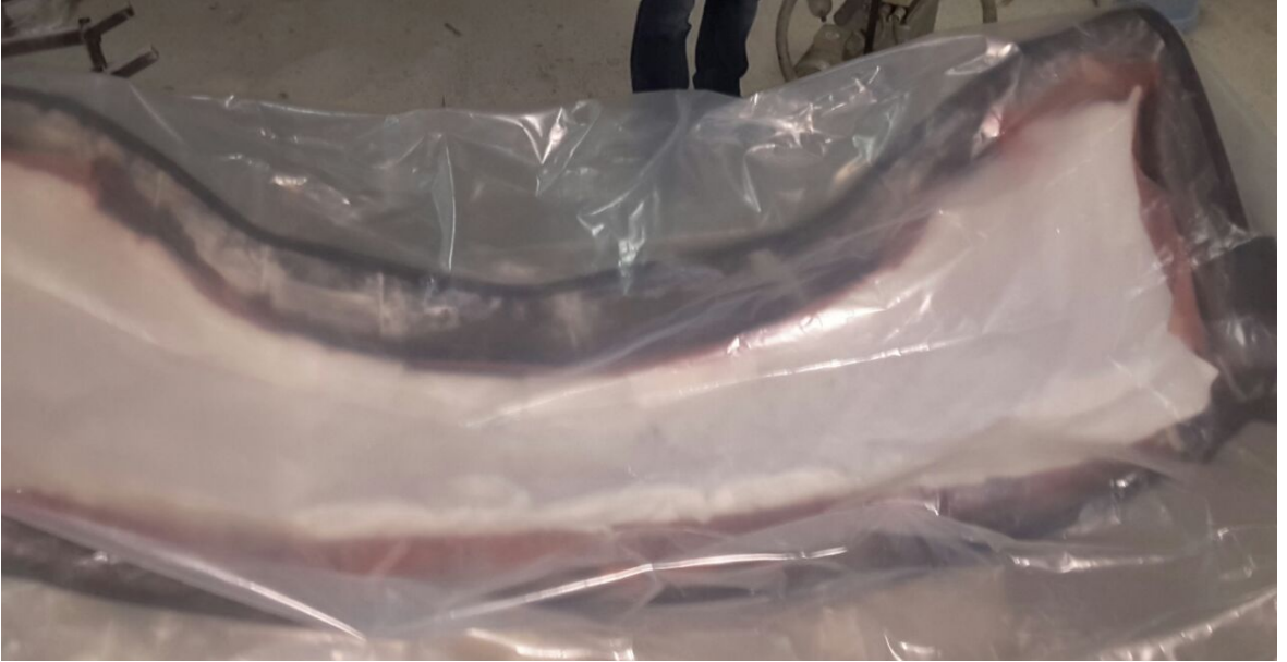
Şekil 5.14 Kullanılan vakum poşeti
