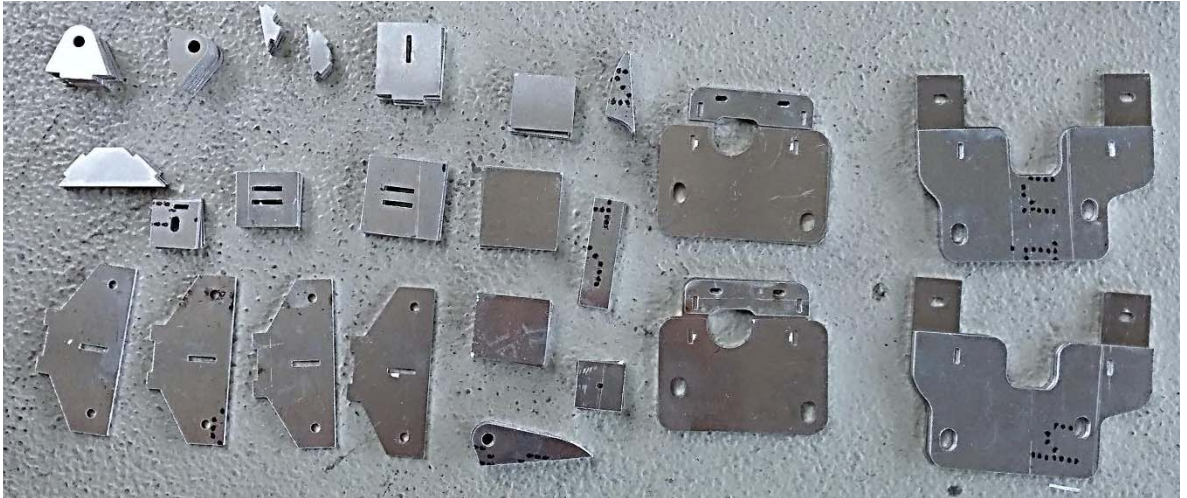
Şekil 5.1 İki boyutlu CNC router ile kesilen parçalar
