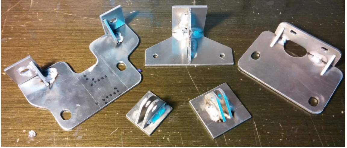
Şekil 5.3 Kaynak işleminden sonra bagaj içi montaj parçaları
