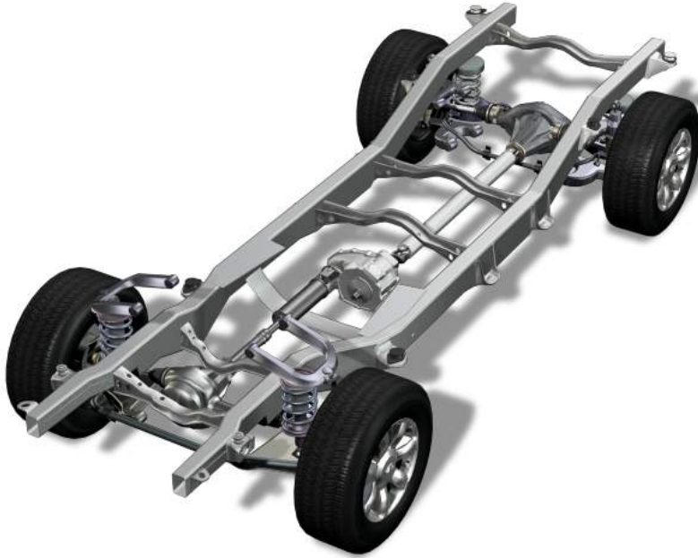
Şekil 1.14 Infinite QX merdiven şasi
