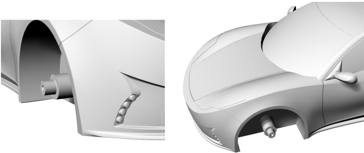
Şekil 3.14 Üç boyutlu yazıcı için hazırlanan 1/14 ölçekli model
