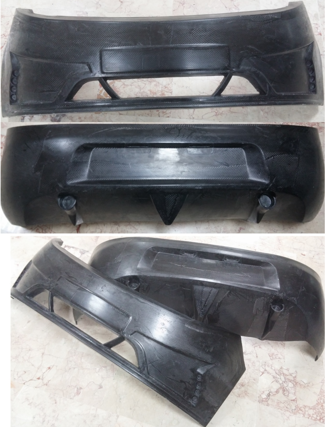
řekil 5.15  retilen  n ve arka tamponlar
