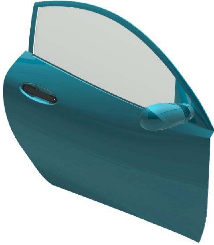
Şekil 4.20 Dış kapı kolu ve dikiz aynası ile tamamlanmış kapı
