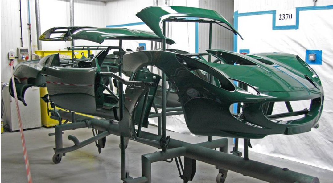
Şekil 1.26 Boyanmış Lotus Elise fiber kompozit body panelleri
