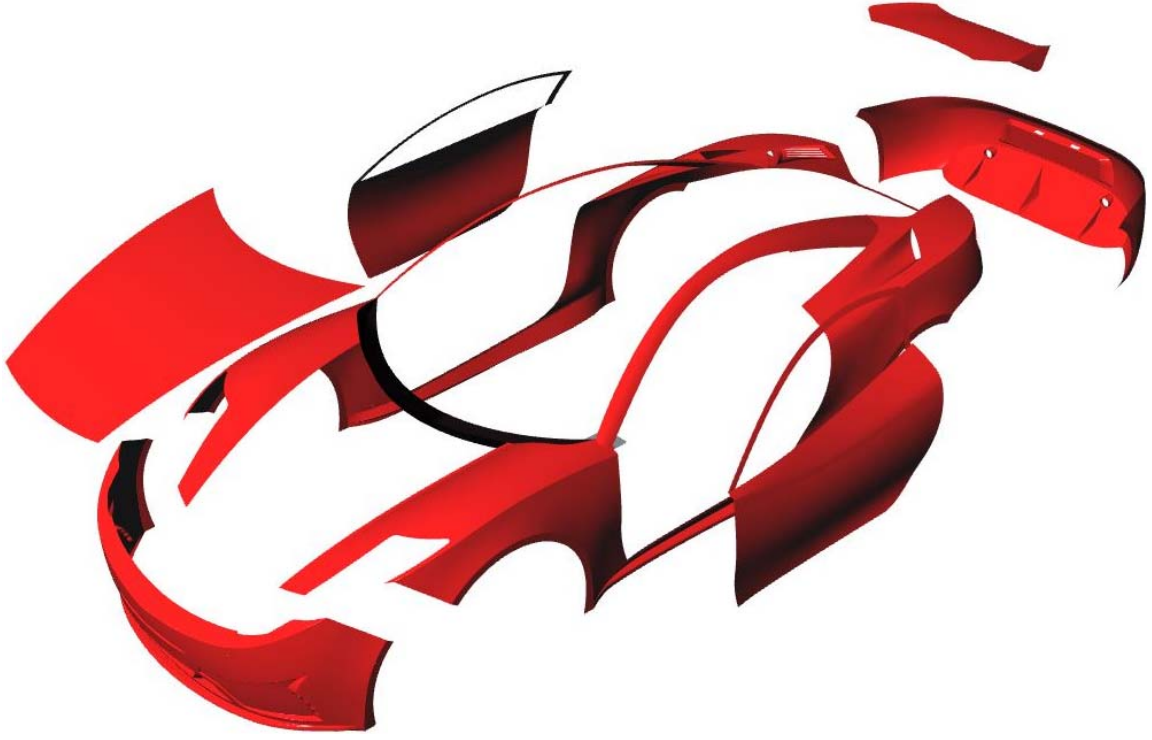
Şekil 3.11 Kesme işleminden sonra oluşan 7 parça
