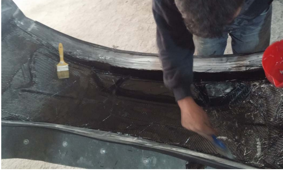
Şekil 5.11 Yatırılan kumaşların reçinelenmesi
