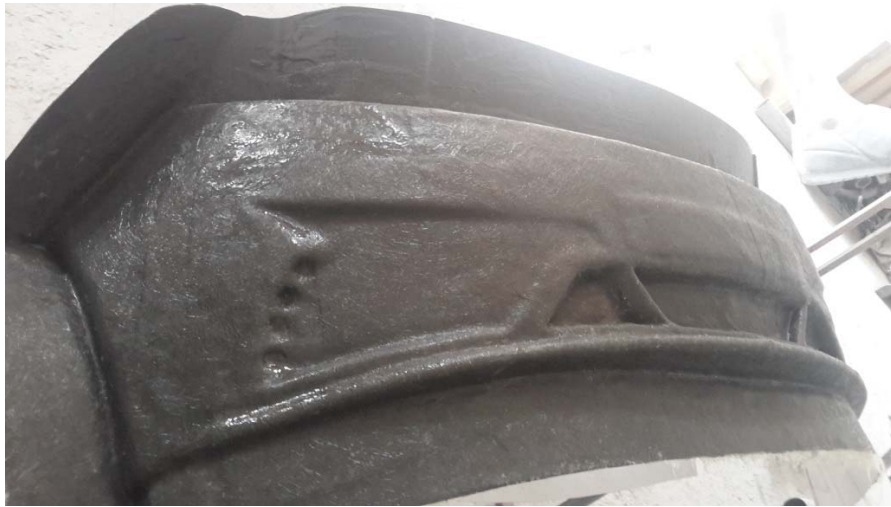
Şekil 5.8 Ön tampon kalıbının hazırlanması
