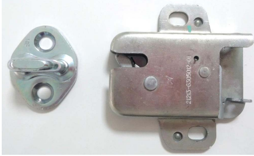
Şekil 4.8 Ön ve arka bagaj kilidi ve karşılığı
