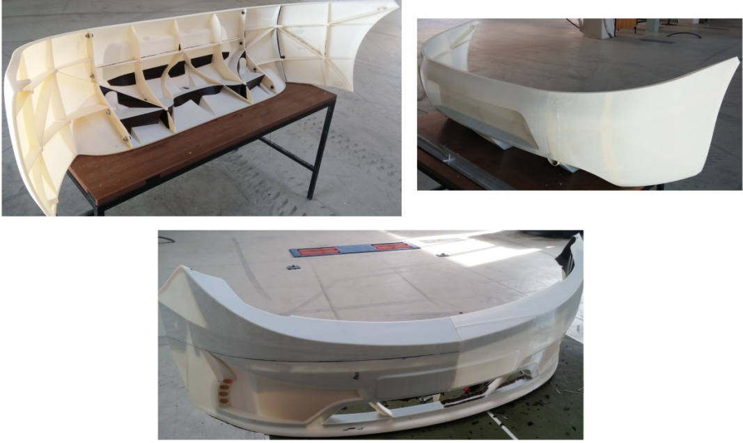
Şekil 5.5 Üç boyutlu yazıcı ile üretilen ön ve arka tampon kalıp modelleri
