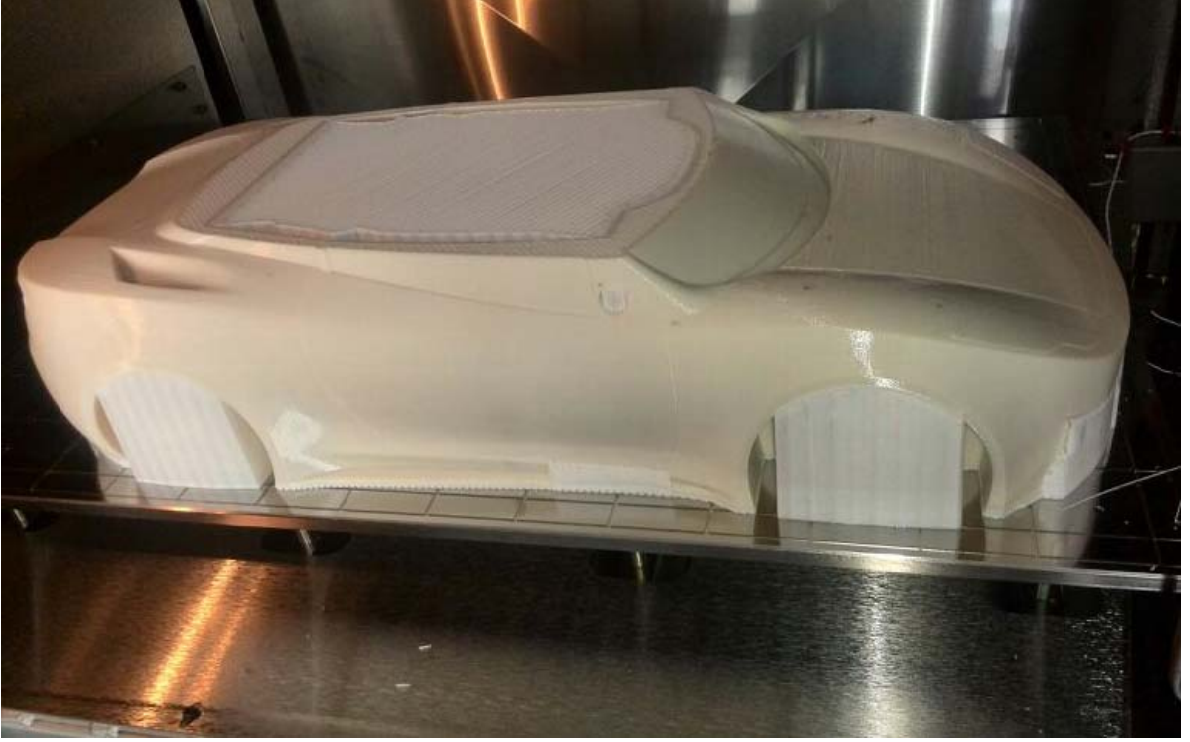
Şekil 3.18 1/5 ölçekli modelin üç boyutlu yazıcı ile üretimi
