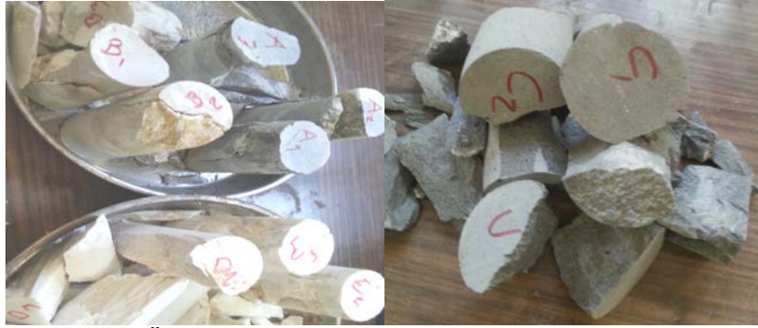
Şekil 4.9. Numuneler Üzerinde Yapılan Nokta Yük Dayanım Deneyi Sonucu Numunelerin Kırılış Biçimleri
