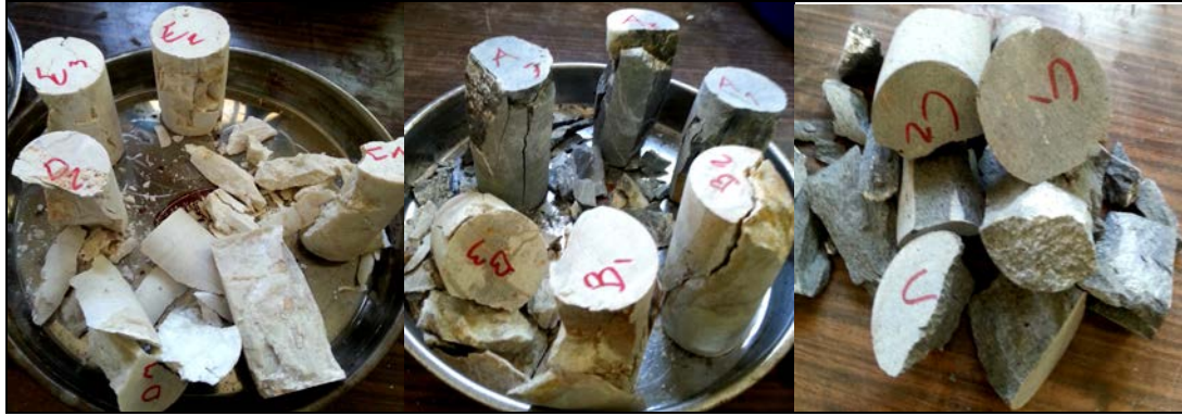
Şekil 4.6. Tek Eksenli Basınç Deneyi Sonucu Kırılan Numunelerin Görüntüsü
