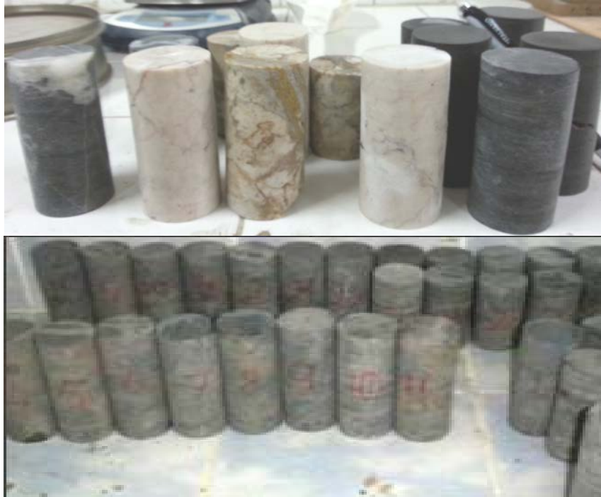
Şekil 4.5. Taş Ocağından alınarak deneye hazır hale getirilen; BX Çap 2BX boyundaki karotların görüntüsü
