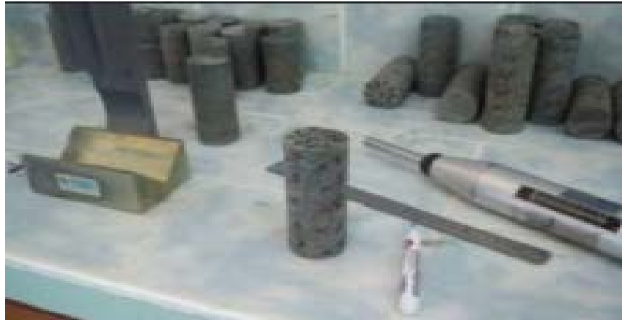
Şekil 3.13. Laboratuvarda Schmidt Çekici ile sertlik belirlenmesi
