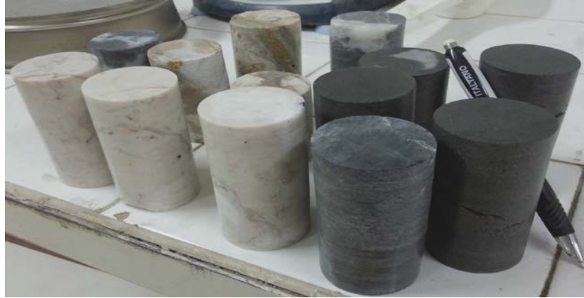
Şekil 4.8. Taş Ocağından alınarak deneye hazır hale getirilen; Boy/Çap oranı L/D = 1.2 olan karotların görüntüsü.
