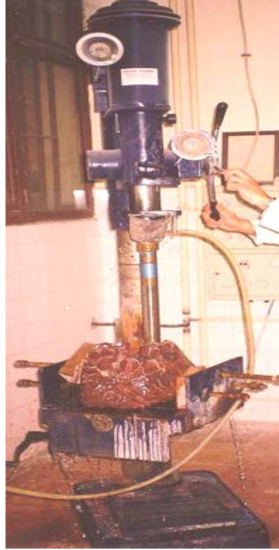
Şekil 3.10. Kaya numunelerinden BX çapında karotun alınışı
