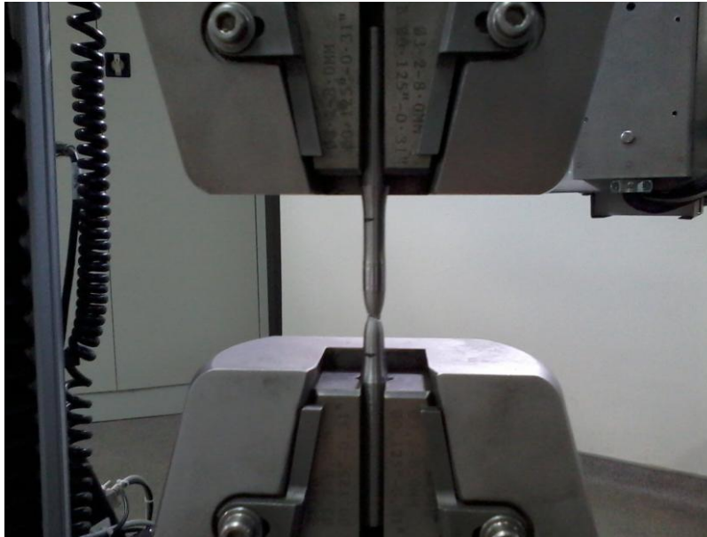
Resim 6.4. Çekme testinde N5 numunesine ait kopma öncesi
