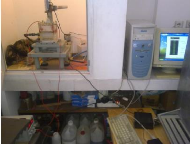
Resim 6.7. İkinci aşama kalıntı gerilme deneylerinde kullanılan katman kaldırma düzeneği
