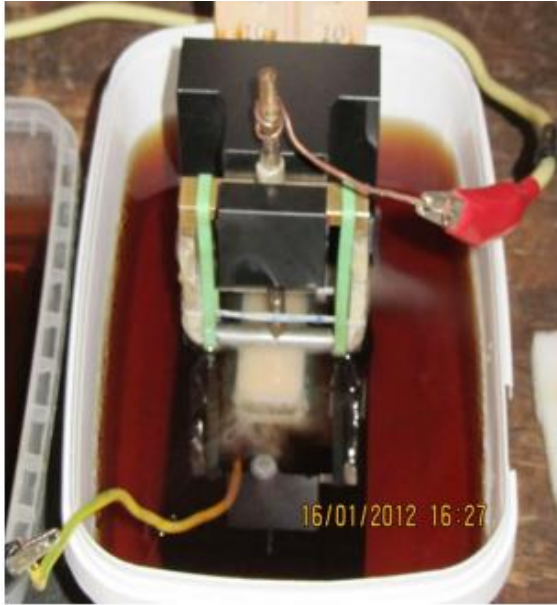
Resim 6.5. İlk deneylerde kullanılan katman kaldırma düzeneği
