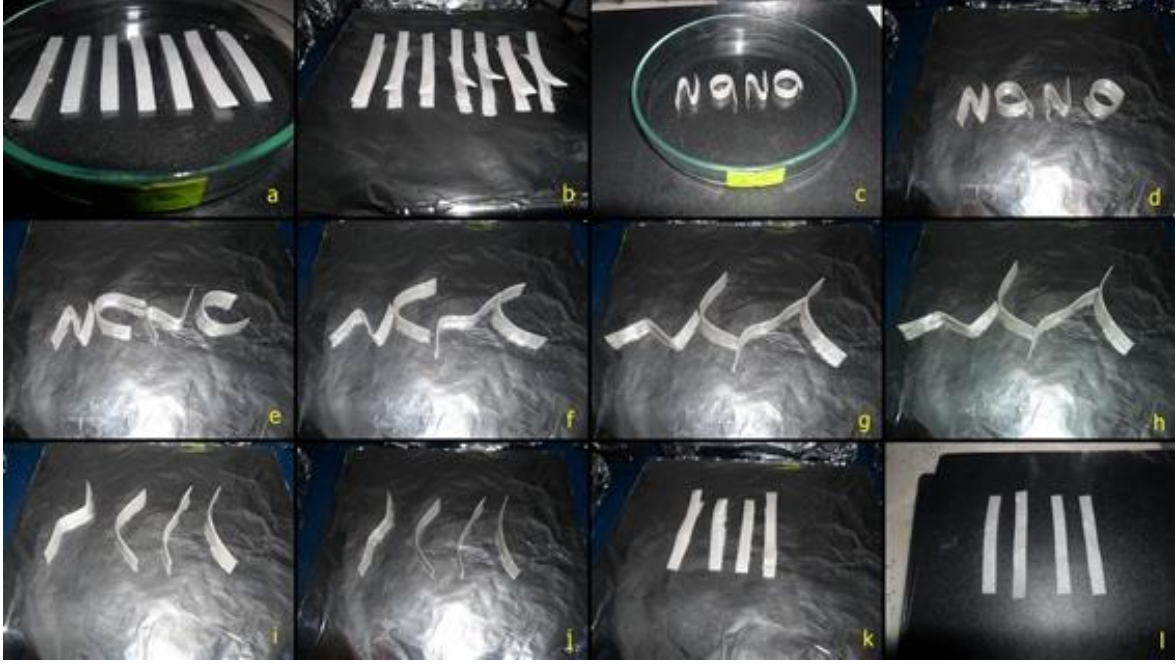
Şekil 7.60. %10 HAP katkılı PVA numunelerinin şekil hatırlama testi a) numunenin ilk şekli b) 130 °C’de 1. s c) 130 °C’de deforme şekli d) 150 °C’de 1. s e) 150 °C’de 10. s f) 150 °C’de 20. s g) 150 °C’de 30. s h) 150 °C’de 40. s i) 150 °C’de 50. s j) 150 °C’de 60. s k) 150 °C’de 90. sm) 25 °C’de numunenin son şekli
