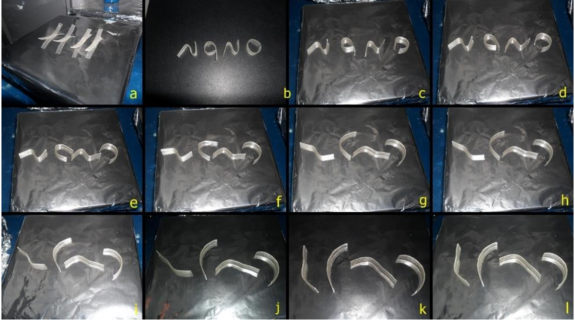
Şekil 7.64. %1 TiO 2 katkılı PVA numunelerinin şekil hatırlama testi a) 130 °C’de 5.dk b) 130 °C’de deforme hali (-5 °C’de 5 dk bekletildi) c) 150 °C’de 1. sd) 150 °C’de 20. s e) 150 °C’de 30.s f) 150 °C’de 40. s g) 150 °C’de 50. sh) 150 °C’de 60. si) 150 °C’de 70. s j) 150 °C’de 80. sk) 150 °C’de 90. s l) 150 °C’de 120. s (son şekli)
