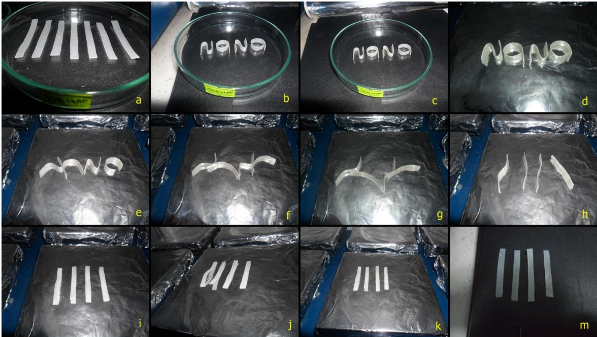
Şekil 7.59. %5 HAP katkılı PVA numunelerinin şekil hatırlama testi a) %5 HAP numunesinin ilk şekli b) 130 °C'deki deforme hali c) -5 °C'de 5 dk sonraki halid) 150°C'de 1. s e) 150 °C'de 10.s f) 150 °C'de 20.
