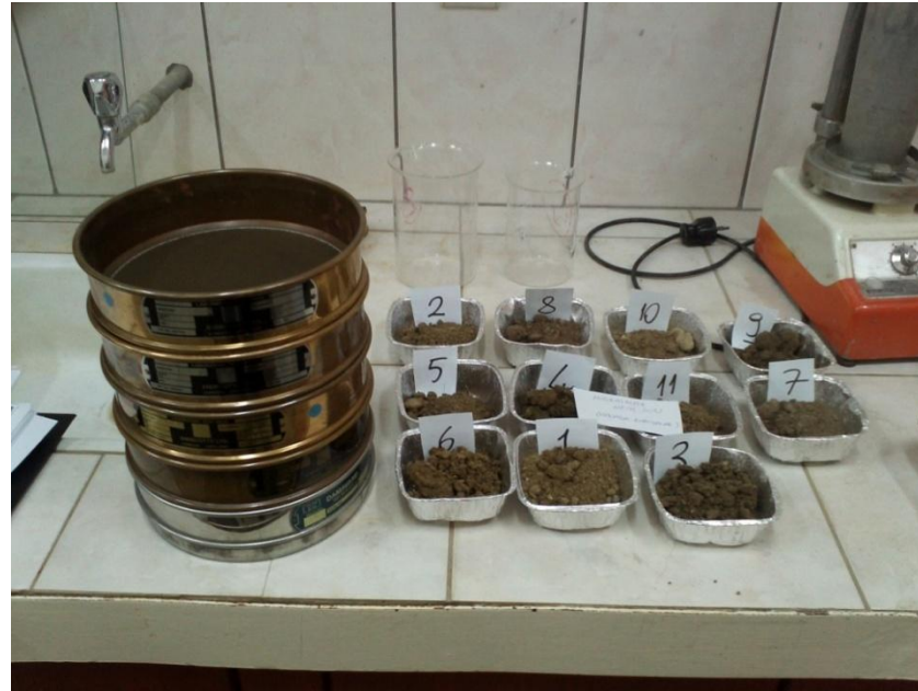
Şekil 3.21. Çalışma alanından alınan örneklerin elek analizi
