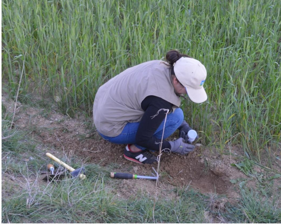
Şekil 3.19 Örselenmemiş toprak örneğinin alınması
