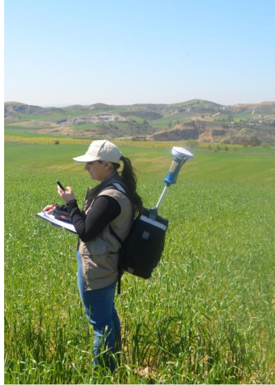
Şekil 3.10. Hassas GPS ile arazide koordinat ölçümü
