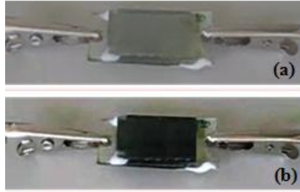
Şekil 3.43 : PAMPSA elektroliti ile yapılmış katı EC cihazın (a) saydam ve (b) renkli hali.
