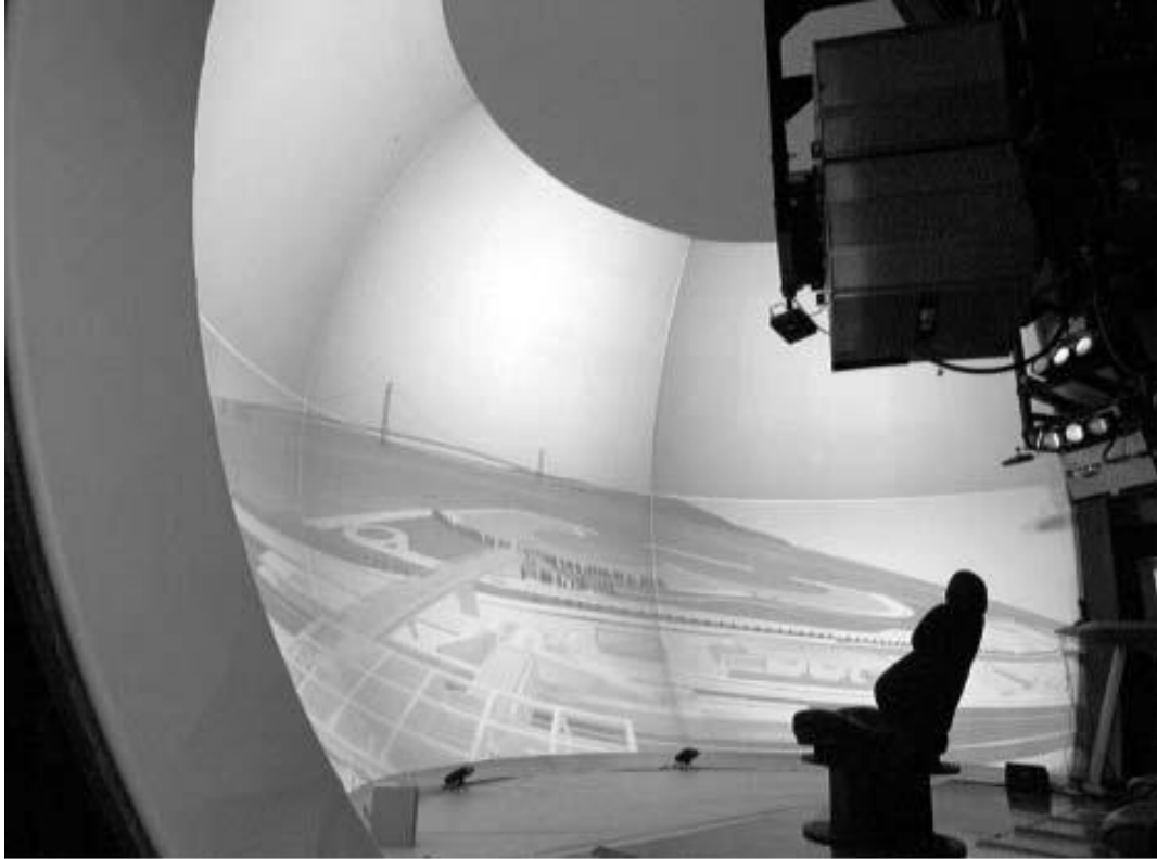
Şekil 4.15 Dalınan sistemlere bir CAVE uygulaması örneği (Whyte, 2002) (Töre, 2010)
