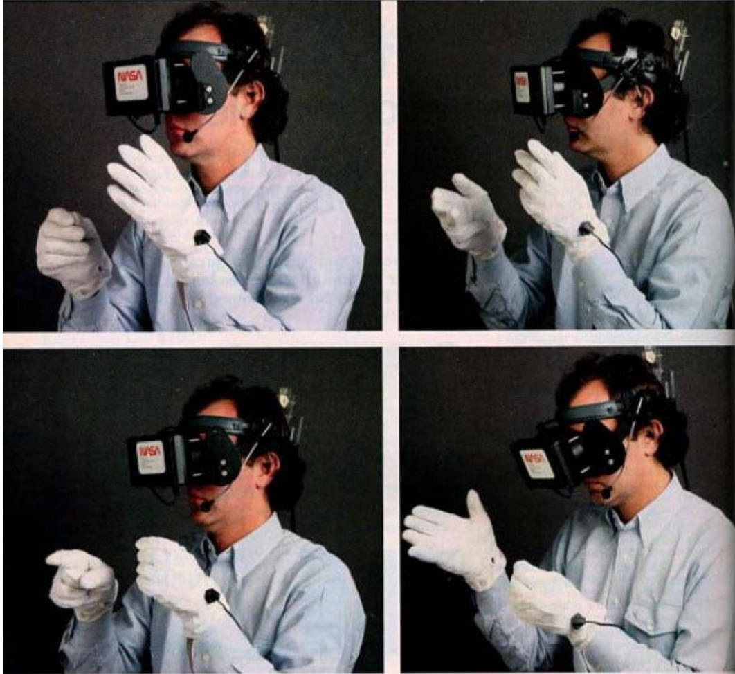
Şekil 4.13 1980'lerde NASA Ames'te tasarlanan başa takılı sunum (Brown, 2003) (Töre, 2010)
