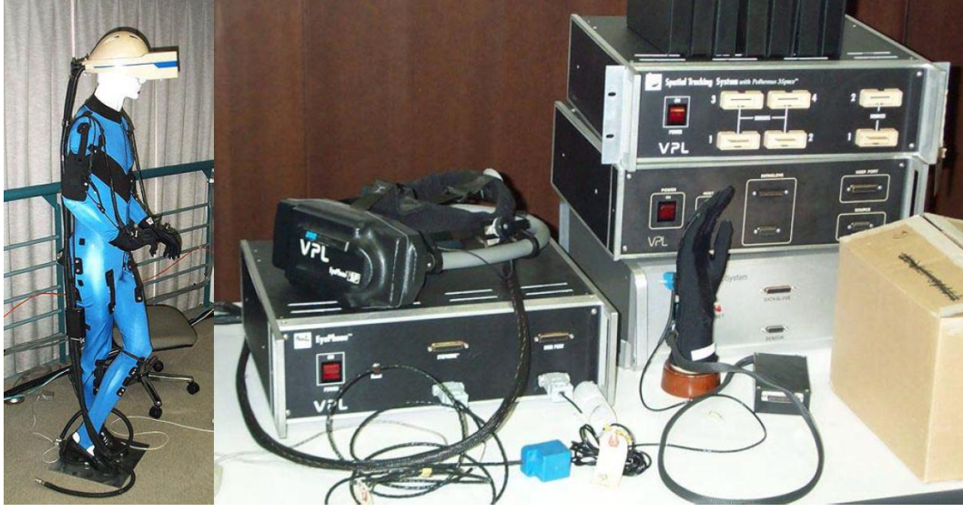
Şekil 4.14 VPL Research tarafından geliştirilen veri eldiveni ve BTS örnekleri (Wikipedia Katılımcıları, 2010) (Töre, 2010)
