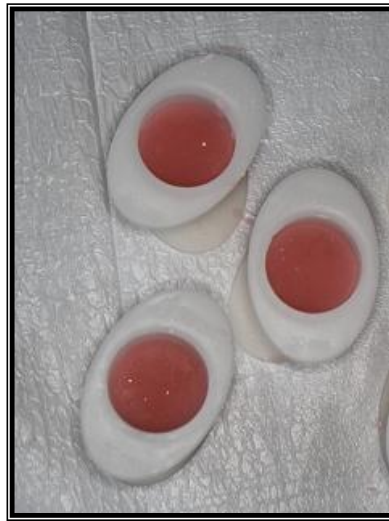
Şekil 3.1: Teflon kalıp ve içerisine dökülen akrilik rezin
