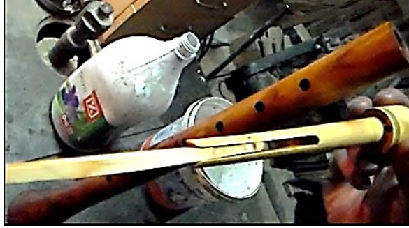
Şekil 7. Zurna dili için “kargacık çubuğu”
