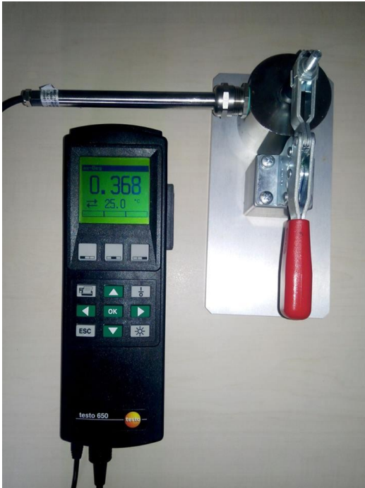
Şekil 1.11. Su aktivitesi ölçüm cihazı
