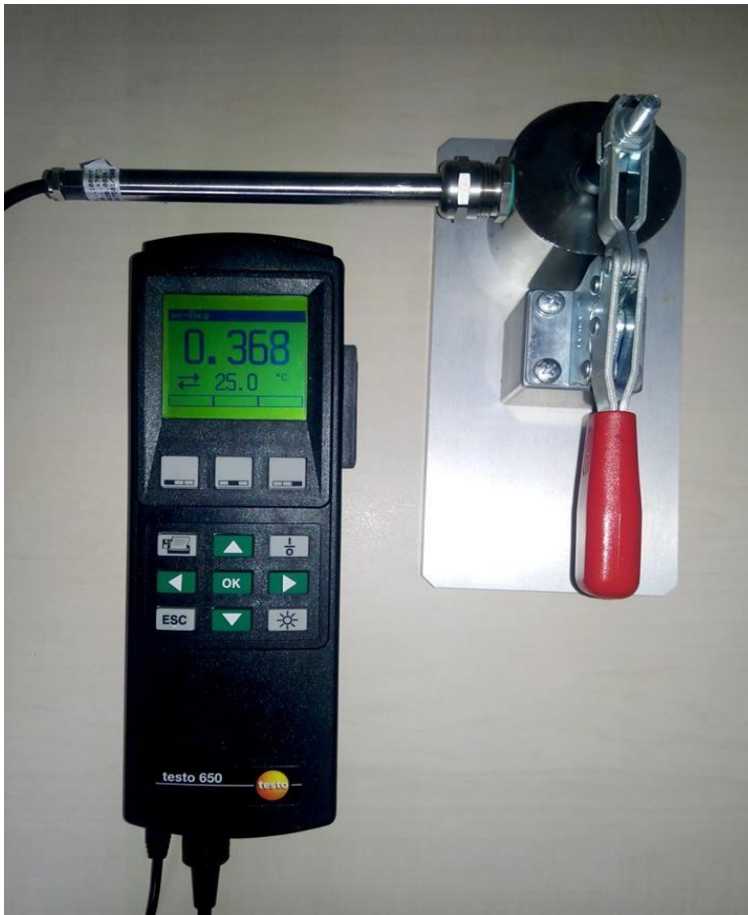
Şekil 8.3. Su aktivitesi ölçüm cihazı
