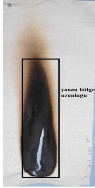
Şekil 2.2: Dikey yanma testi sonrasında yanan bölge uzunluğunun ölçümü.
