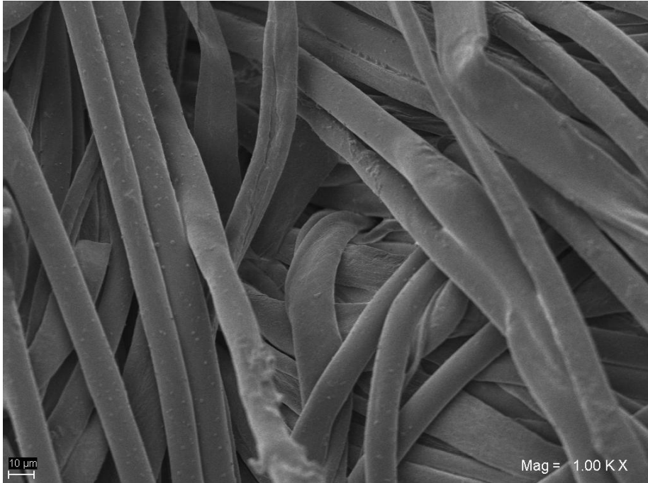
Şekil 3.16: 400g/L Apreli %50/50 Pamuk/Polyester kumaşın SEM görüntüsü.
