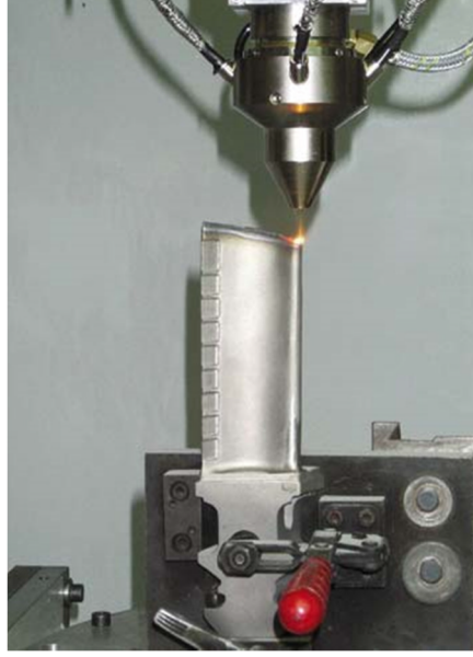
Şekil 2.10 : Tek kristalli türbin pervane kanadının lazer kaynağı ile onarımı [14].
