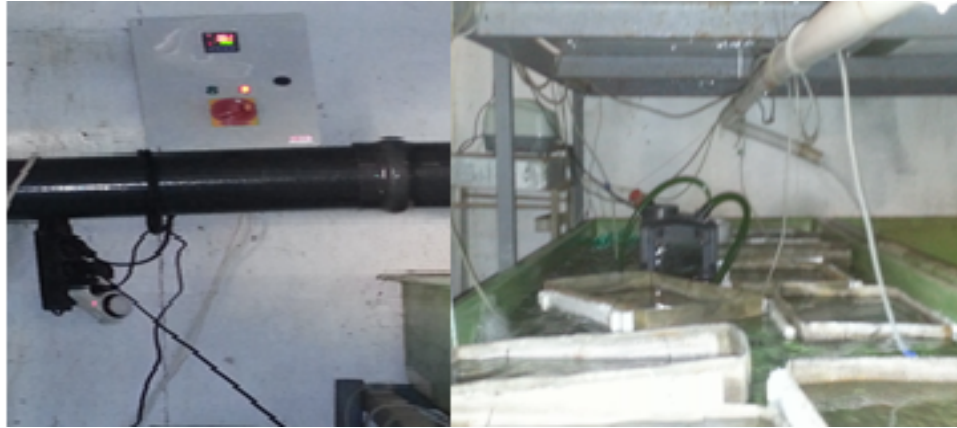
Şekil 2.11: Sıcaklık uygulamalarının yapıldığı tank düzeneği
