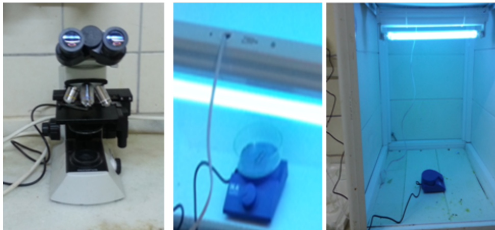
Şekil 2.3: Işık mikroskobu, UV lamba, manyetik karıştırıcı
