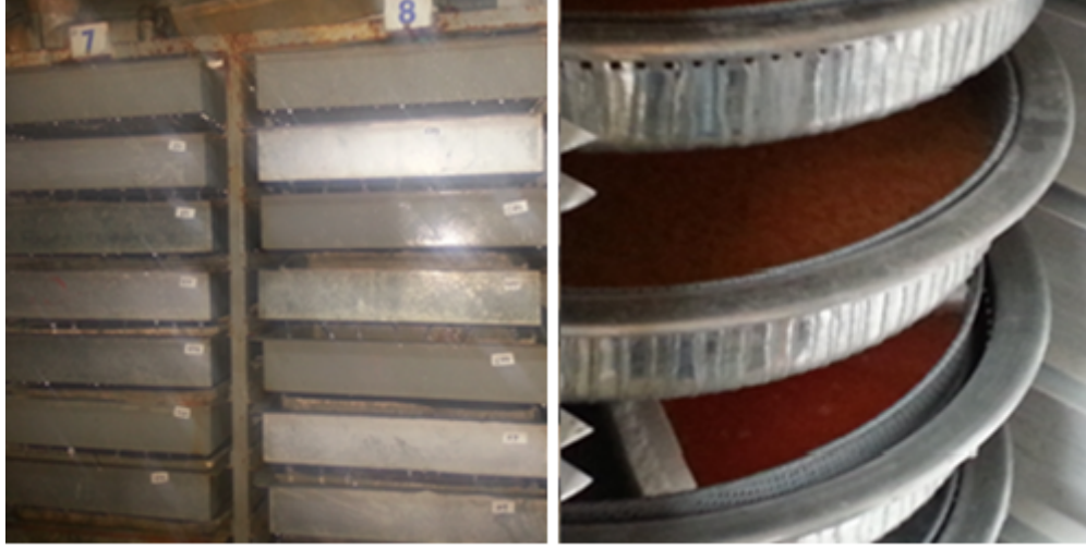
Şekil 2.10: Fethiye (solda) ve Bergama’da (sağda) kullanılan kuluçka dolapları
