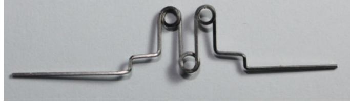
Resim 2. Apareyin Aktif Komponenti 0.017 X 0.025 İnch TMA Telinden Hazırlanan Üçlü Helikal Zemberek
