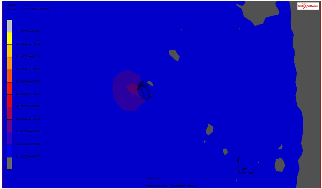
Şekil 66: Tek mini-vida uygulanan blok kemik modelinde, spongiyoz kemikte maksimum asal gerilme izlenen bölgeler
