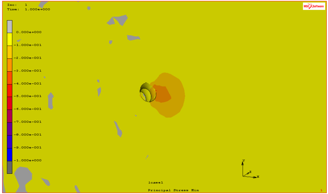
Şekil 70: Tek mini-vida uygulanan blok kemik modelinde, spongiyoz kemikte minimum asal gerilme izlenen bölgeler
