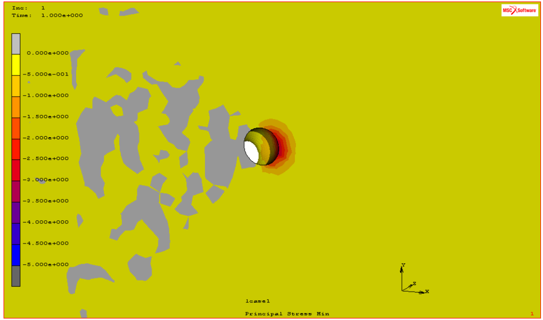
Şekil 52: Tek mini-vida uygulanan blok kemik modelinde, kortikal kemikte minimum asal gerilme izlenen bölgeler
