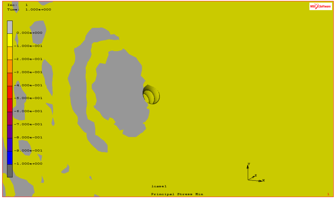
Şekil 71: MIR (1 mm) ile birlikte tek mini-vida uygulanan blok kemik modelinde, spongiyoz kemikte minimum asal gerilme izlenen bölgeler
