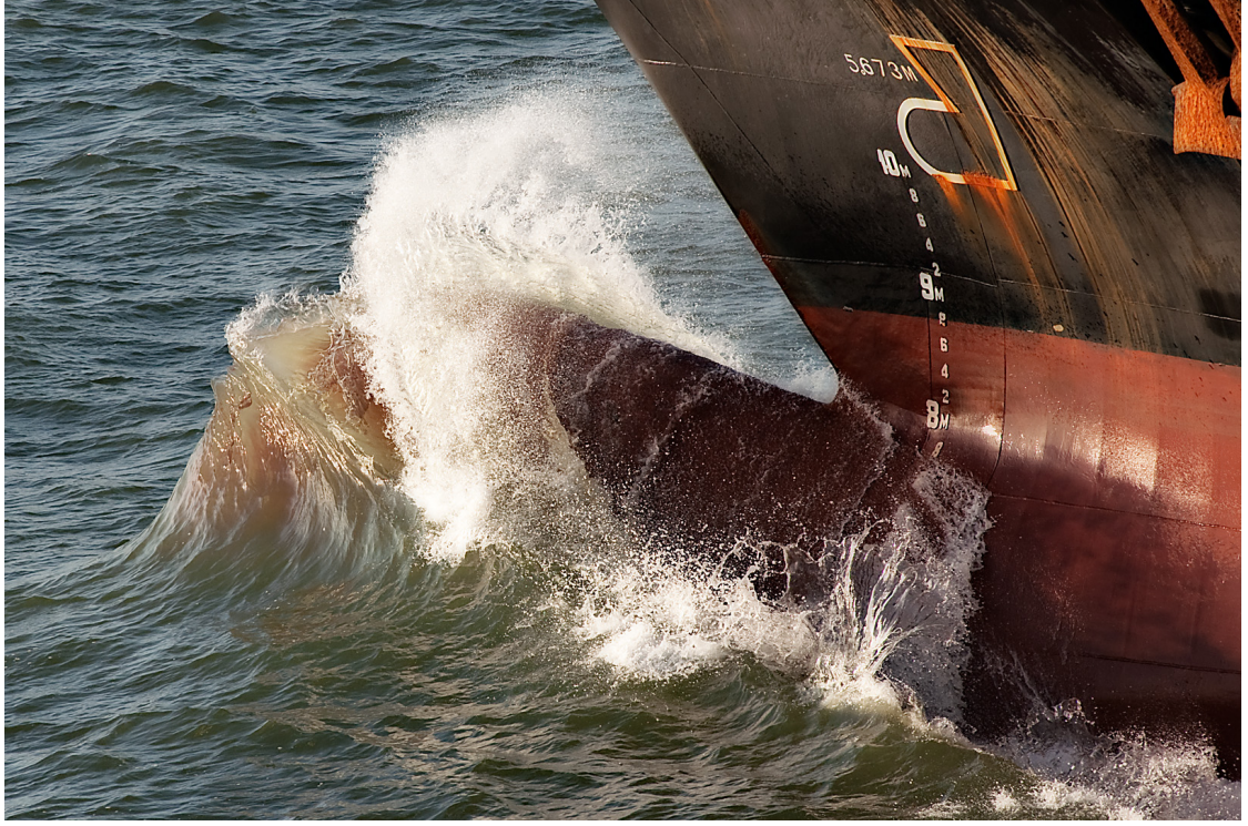
Şekil 1.2: Gemi baş tarafında oluşan dalga kırılması hadisesi.
