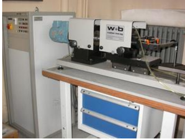
Şekil 6.6 : Walter+Bai UBM 0,1-500Nm marka sabit dönel eğmeli yorulma test cihazı.
