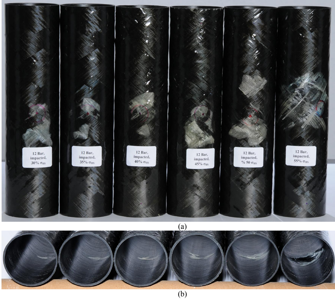
Şekil 7.63 18 MPa teğetsel ön gerilme değerinde darbe ile hasarlandırılmış hibrit boru numunelerinin farklı gerilme değerlerinde yorulma sonrası hasarın a) dış yüzey ve b) iç yüzey genel görünüşü
