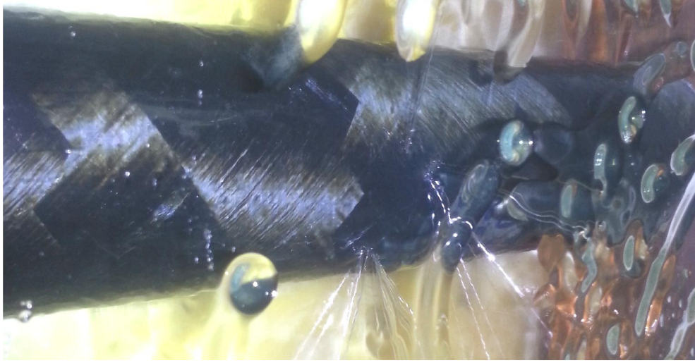
Şekil 7.35 Hasarsız hibrit kompozit boru numunelerinde %50 \sigma_{HS}=226,5 MPa gerilme değerlerinde N=3184 çevrimde yorulma esnasında oluşan yoğun sızıntının sonuç hasarı görünüşü
