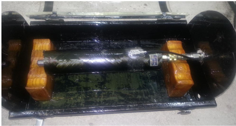
Şekil 6.10 İç basınç test aparatı yerleştirilmiş deney numunesi ve muhafaza kabini
