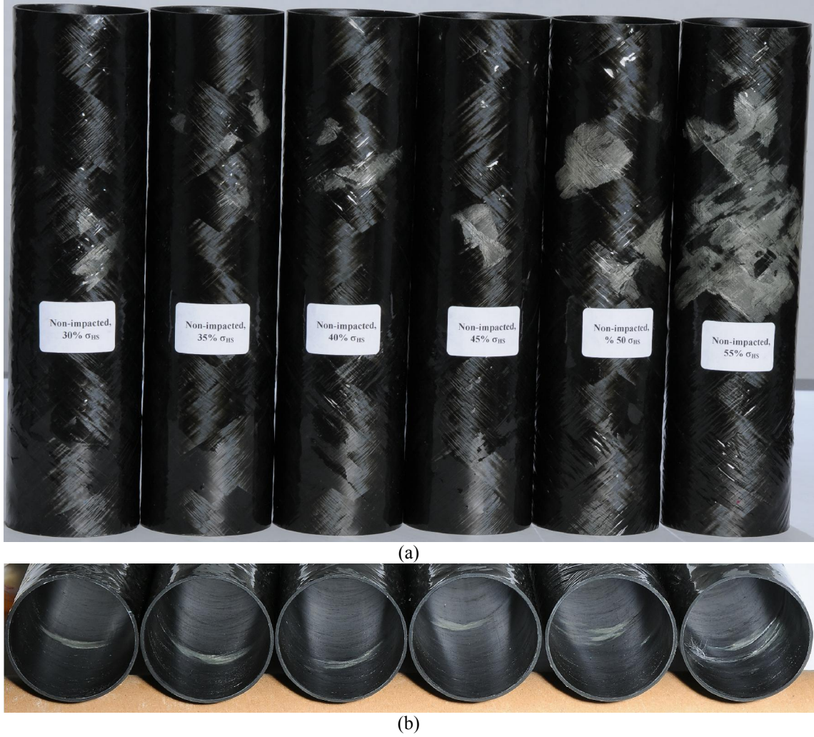
Şekil 7.36 Hasarsız hibrit kompozit boru numunelerinin farklı gerilme değerlerinde yorulma sonrası hasarın a) dış yüzey ve b) iç yüzey genel görünüşü
