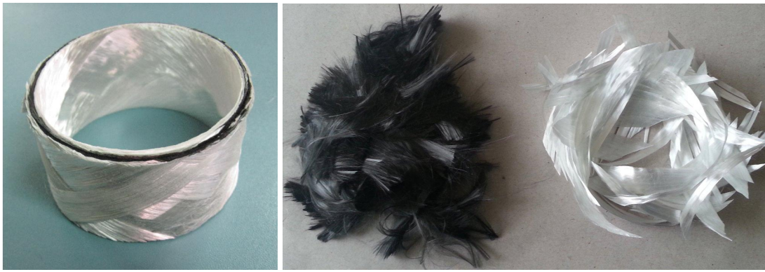
(a) (b) Şekil 7.1 a) yakılmış deney numunesi b) ayrılmış karbon ve cam elyaflar
