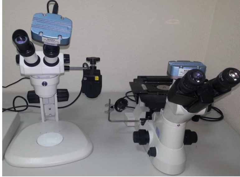
Şekil 6.17 Mikro hasarın incelenmesinde kullanılan KOZO marka USB mikroskop kameralar
