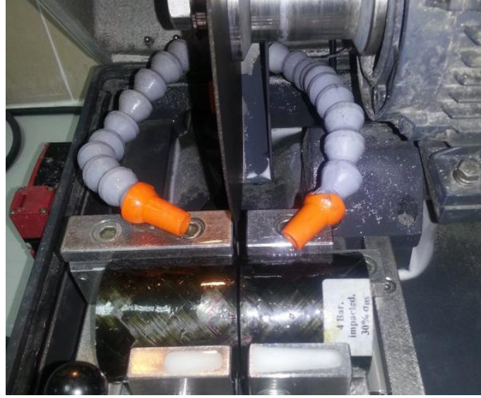
Şekil 6.15 Numunelerin kesme işleminde kullanılan METKON marka kesme cihazı
