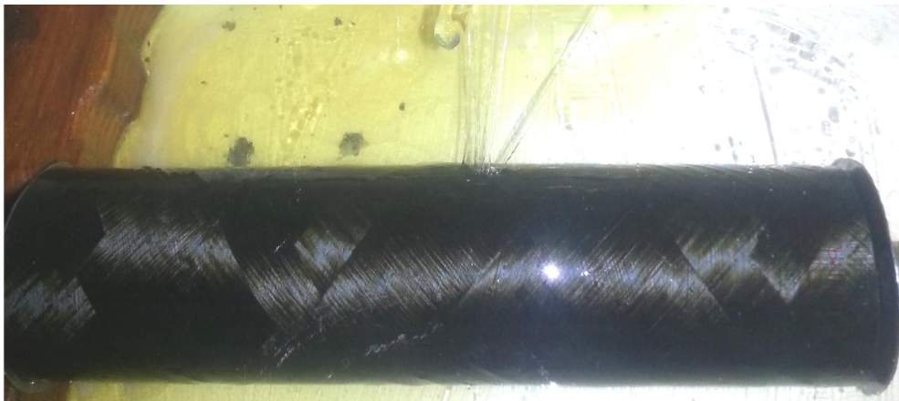
Şekil 7.34 Hasarsız hibrit kompozit boru numunelerinde %30 \sigma_{HS}= 135,9 MPa gerilme değerlerinde N=444.200 çevrimde yorulma esnasında oluşan yoğun sızıntının sonuç hasarı görünüşü
