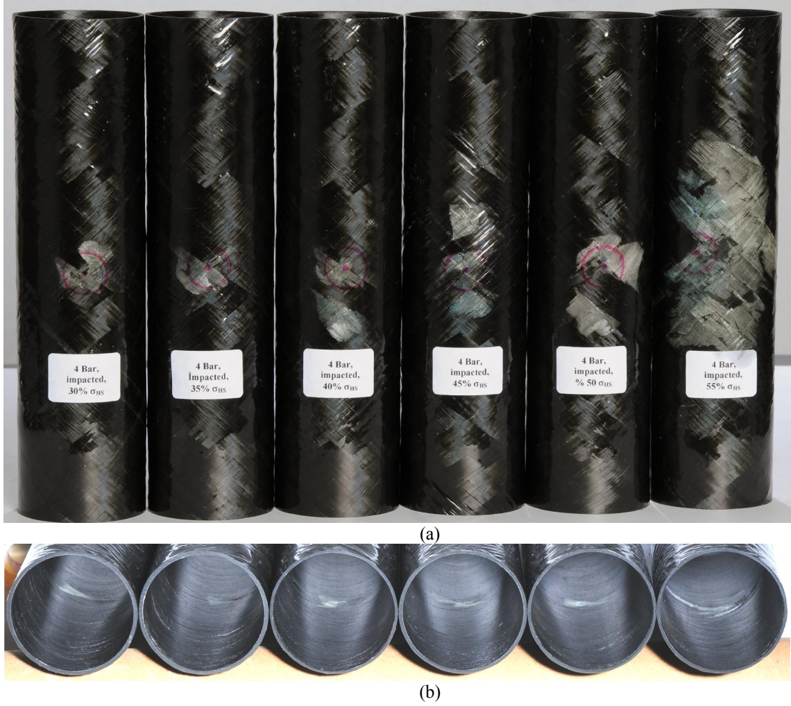
Şekil 7.45 6 MPa teğetsel ön gerilme değerinde darbe ile hasarlandırılmış hibrit boru numunelerinin farklı gerilme değerlerinde yorulma sonrası hasarların a) dış yüzey ve b) iç yüzey genel görünüşü
