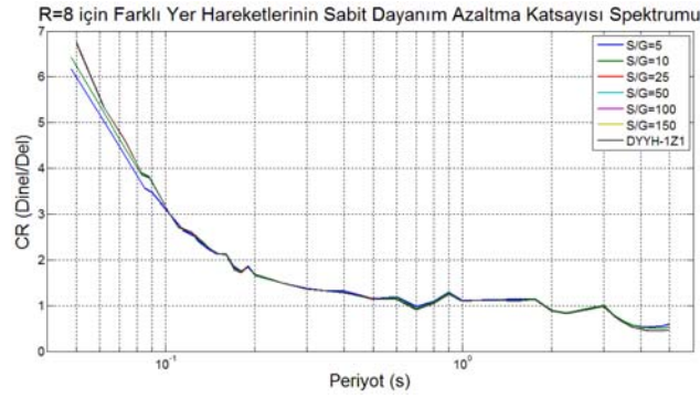
Şekil G.1 : 1. derece Z1 zemin sınıfına ait tasarım spektrumuna uygun üretilen farklı gürültü oranlarına sahip depremlerin sabit dayanım azaltması katsayısı spektrumları.
