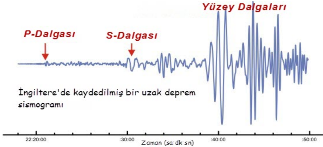
Şekil 2.7 : Sismogram üzerinde cisim ve yüzey dalgaları [Url-4].
