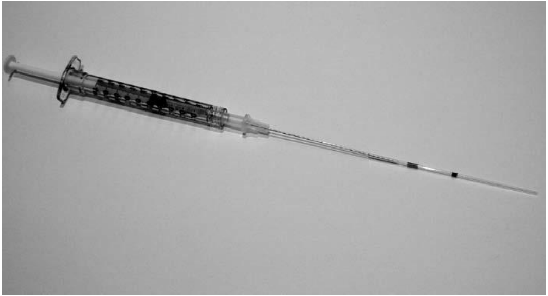
Şekil 9. Spatial rezolüsyonda kullanılan ^{18}\text{F} damla konulmuş kapiller tüp
