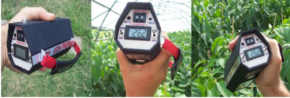
Şekil 2.3: Sera içi ölçümlerde kullanılan infrared termometre cihazı
