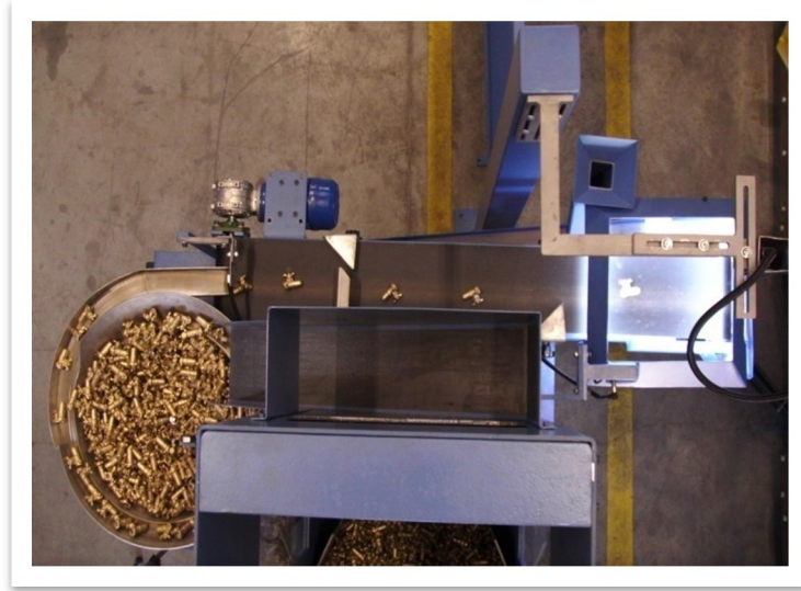
Şekil I.51 Kameralı Sistem ile Alınan Parçayı Besleme Sistemi
