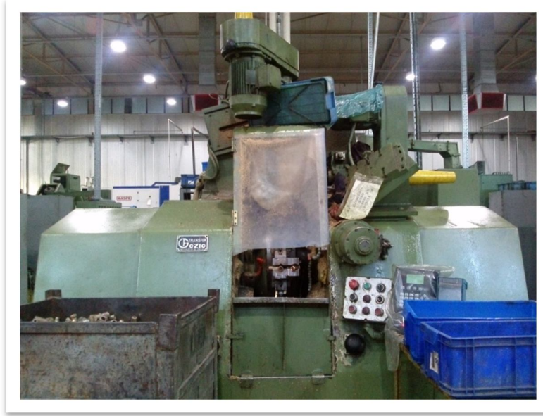
Şekil IV.4 Projedeki Çamaşır Musluğunu İşleyen Hidrolik Bir Transfer Makinesi
