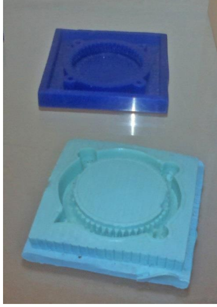
Şekil 5.5 : 3B yazıcıda üretilen parça üzerinden alınan silikon kalıp.
