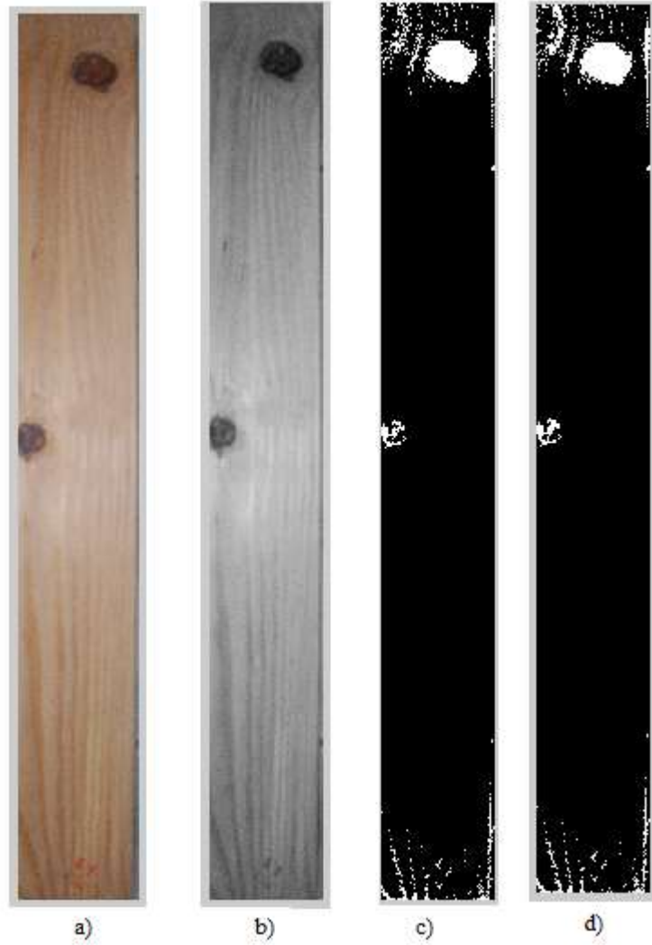
Şekil 4.16 Döşemelik tahtanın ön işlemleri: a) Orijinal görüntü, b) Gri seviye görüntü, c) Eşiklenmiş görüntü, d) Deliklerin doldurulmuş görüntü
