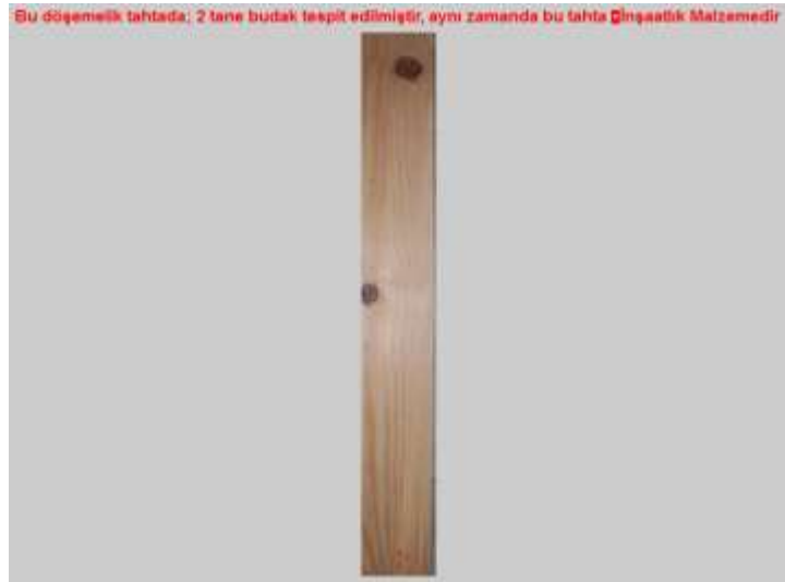
Şekil 4.24 TS 11970 standardına göre kalitesi belirlenmiş döşemelik tahta
