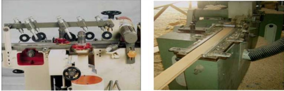
Şekil 3.1 Profil ve rabita makinesinde lambri yapılması (Anonim, 2007)
