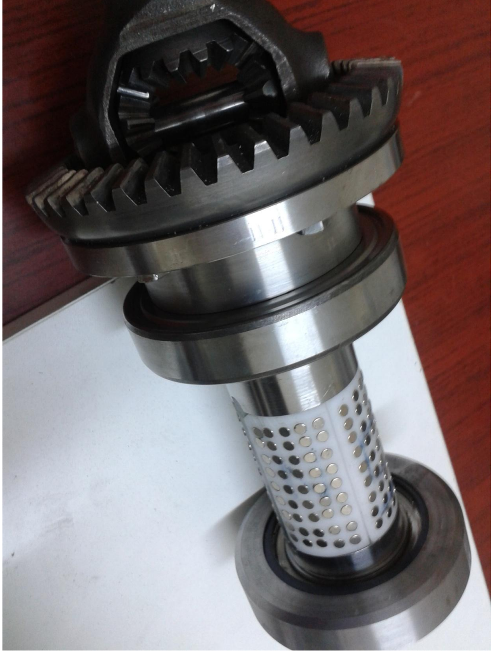
Şekil C.3. İmal edilen taşıyıcı ve diferansiyel dişlileri
