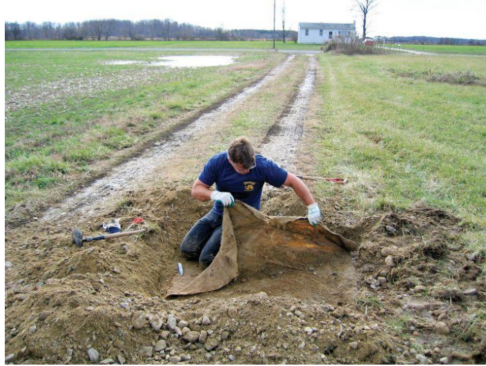
Şekil 2.10: 1972 yılında yol dolgusu altına yerleştirilen geotekstil malzemenin 35 yıl sonra çıkarılması.
