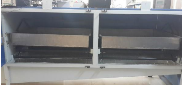
Şekil 3.3. Sürekli tartım ve kayıt sistemine ait yük hücresi ve askı düzeni
