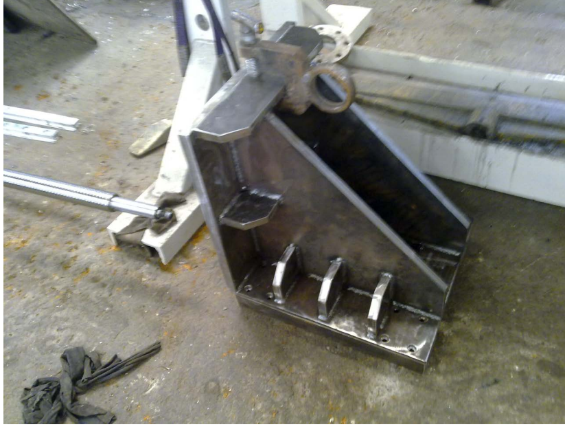
Şekil 4.17 – Mekanik montaj boya öncesi
