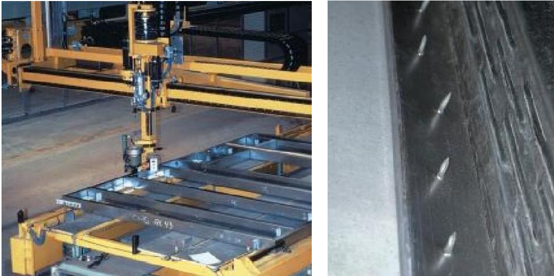
Şekil 4.51 : Hazır duvar panel üretimi ve hafif çelik profilde balistik tırnaklı çivi, Rautaruukki Oyj, Finlandiya) [5]
