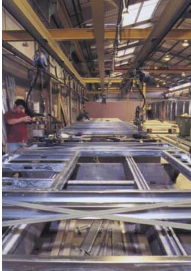
Şekil 3.13 : Hafif çelik çerçeveleme panellerin (gelişmiş) fabrika üretimi [17]
