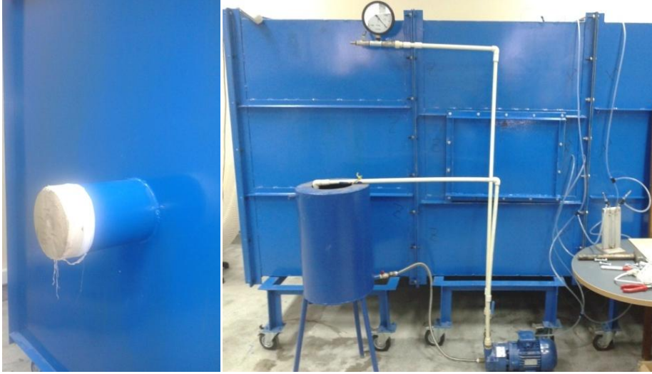
Şekil 4.9 : Sızdırmazlık testinin yapılışı.
