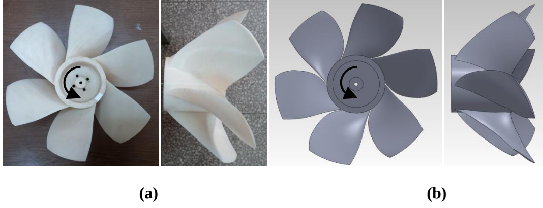
Şekil 8.10 : 45° pozitif yönde öteleme uygulanmış fanın (PD035-45) (a)fotoğrafı. (b)katı modeli.
