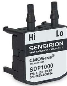
Şekil 4.11 : Lülelerin giriş ve çıkışları arasında kullanılan basınç sensörü.
