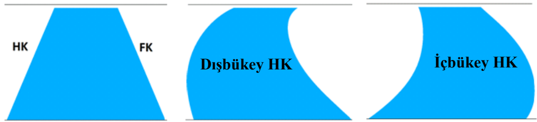
Şekil 7.15 : Hücüm kenarı kaydırması uygulanmış fanların r-z düzlemindeki (meridyenel düzlem) görünüşleri.
