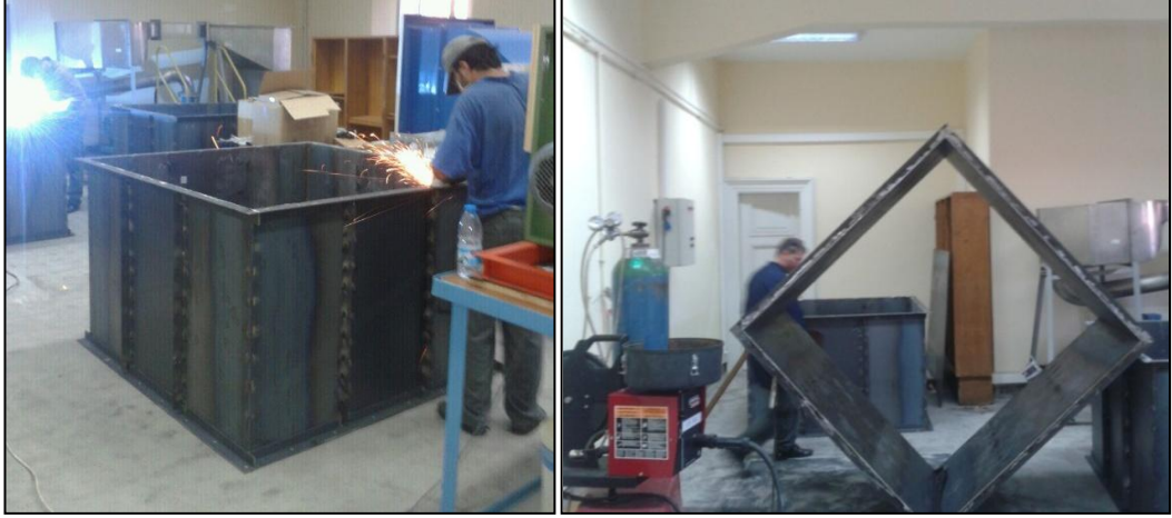
Şekil 4.5 : Gaz altı kaynağı ile sızdırmazlığın sağlanması.
