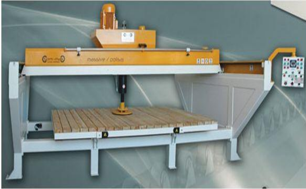
Şekil 3.9. Köprülü silme- cilalama makinaları ( http://www.som-mak.com )
