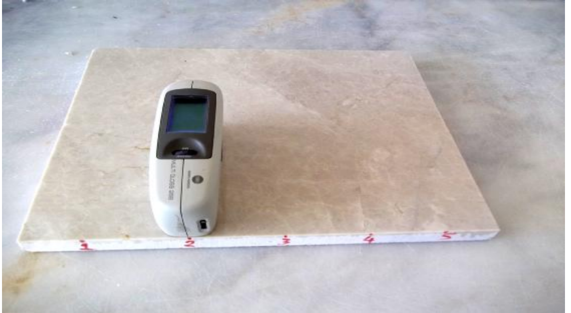
Şekil 4.10. Yüzey üzerinde parlaklık ölçümü
