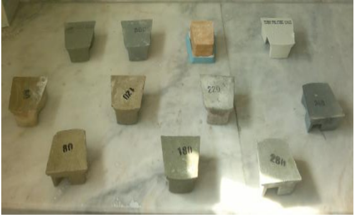
Şekil 4.5. Aşındırma-cıtalama işlemi için kullanılan aşındırıcı serisi
