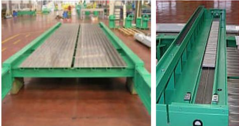
Şekil 3.8. Bantlı silme-cila makinası köprü ünitesi (MEGEP b, 2008)
