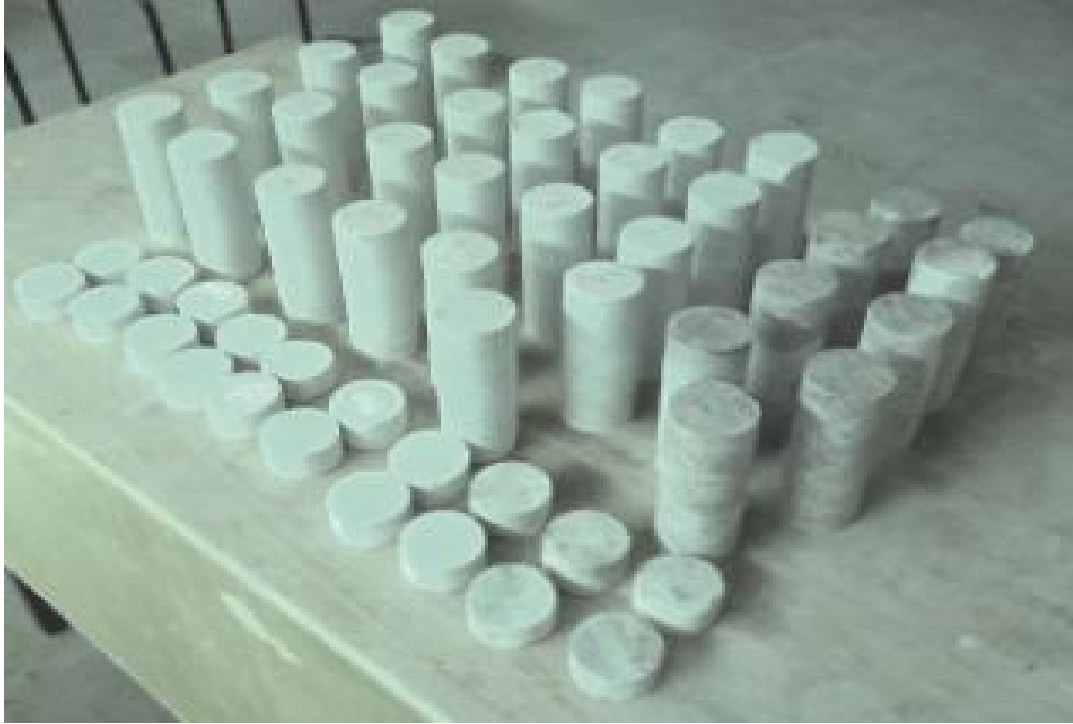
Şekil 4.1. Mermer birimlerinin fiziksel ve mekanik özellikleri belirlemek üzere hazırlanan numuneler
