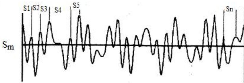
Şekil 3.17. Yüzey Pürüzlülüğü Ölçümünde Sm değeri (Rank Taylor Habson, 1992)
