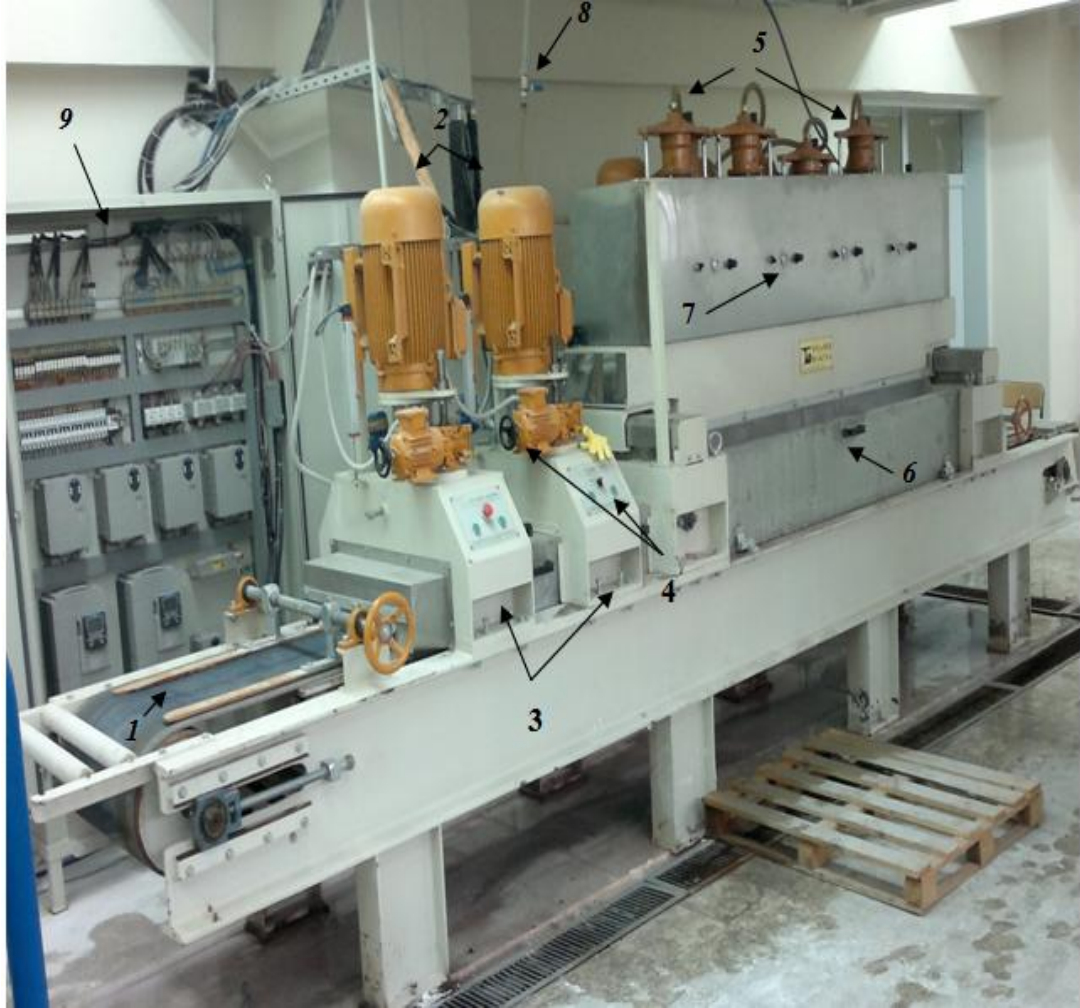
1-Bant 2-Kalibre kafaları 3-Kalibre muhafazası 4-Kalibre ayar mekanizması 5-Silim kafaları 6-Silim kafaları muhafazası 7-Silim kafası basınç ayarı 8-Su vanası 9-Makina kontrol sistemi Şekil 4.3. Laboratuvar ölçekli aşındırma-cilalama makinası
