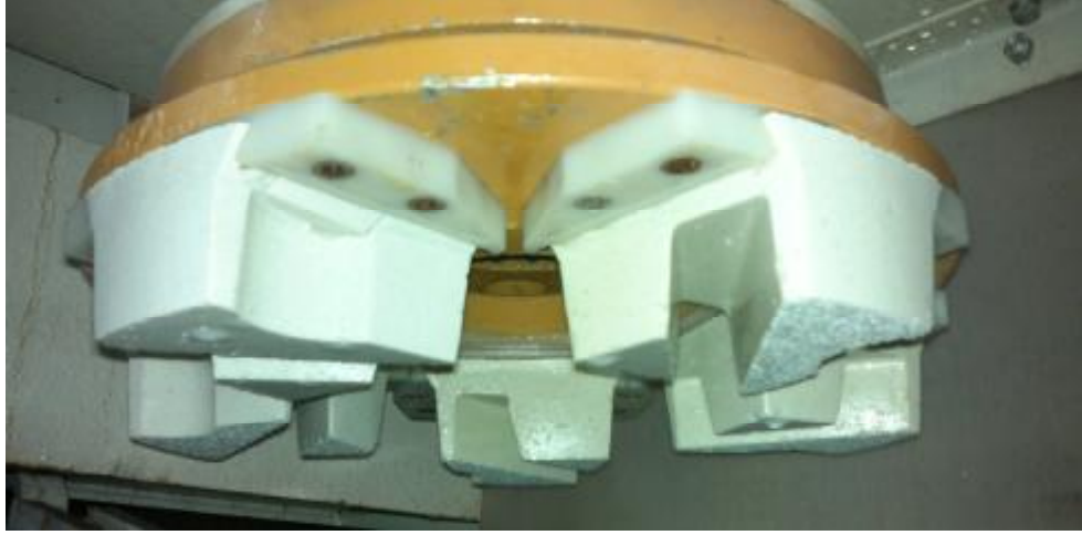
Şekil 3.7. Aşındırıcı takılmış silim kafası
