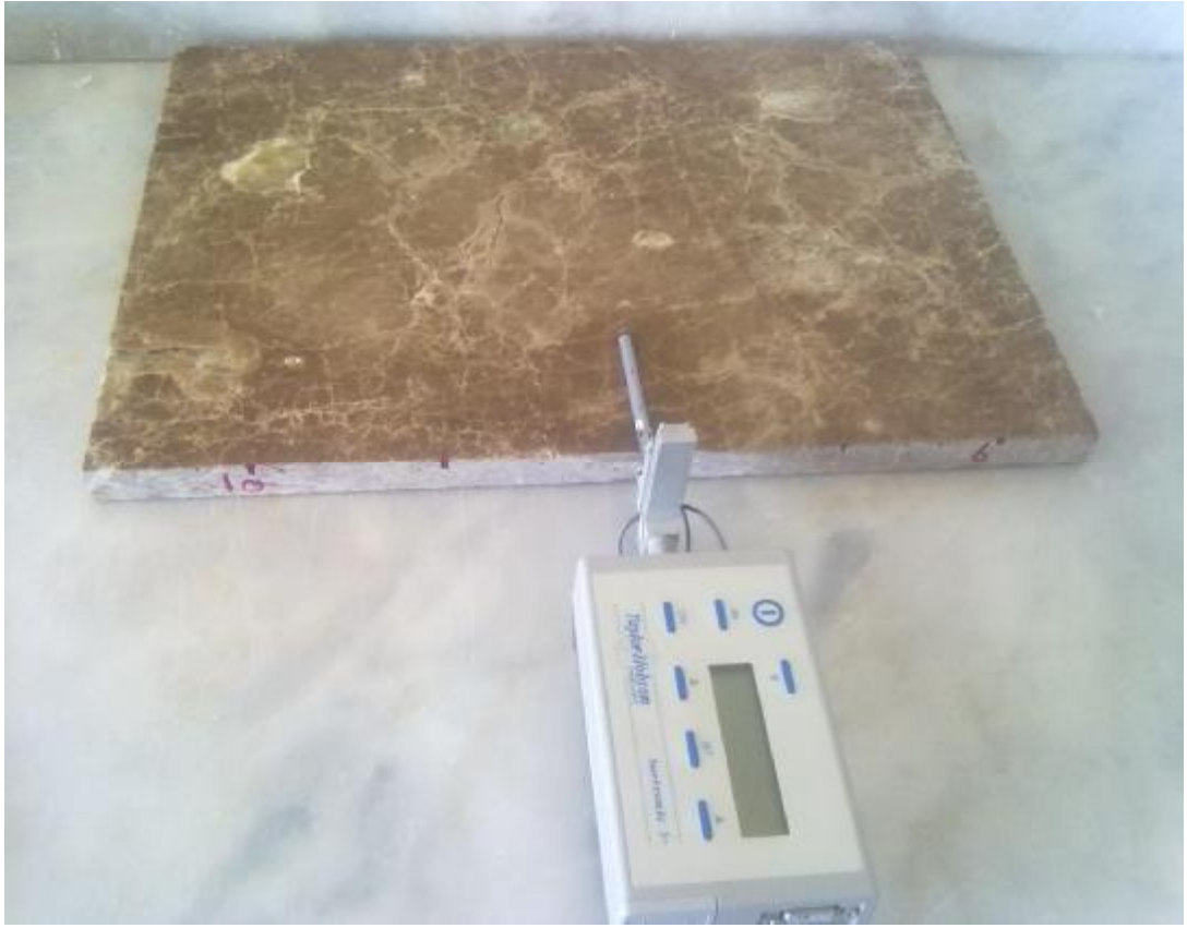
Şekil 4.8. Yüzey üzerinde pürüzlülük ölçümü
