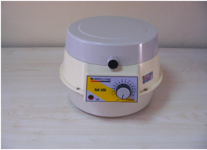
Şekil 8. Elektro-mag M18 mikrohematokrit santrifüj (Orjinal).
