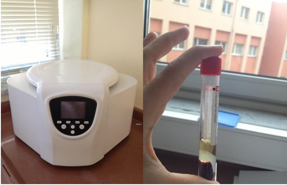
Şekil 6. Herexi marka santrifuj cihazı ve biyokimya tüpünde kanın plazma kısmına ayrılması (Orijinal).
