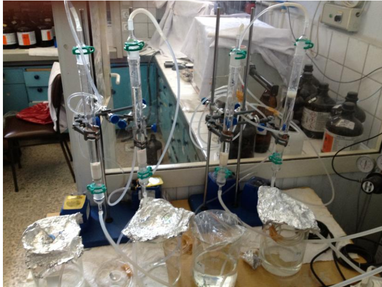
Şekil 5.5: Reçine adsorpsiyon düzeneği.
